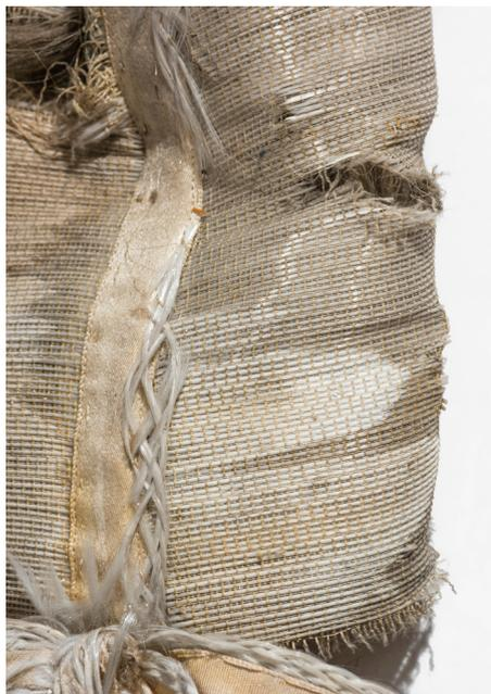
Abb. 42 Ausgefrante Löcher und Enden der Flechtbänder
