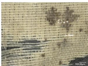
Abb. 92 Verkrustete und kristalline Auflagen, Faserbrüche (DM06\_KDM03\_AL\_20161006).
