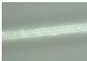
**Abb. 17** Aufliegendes Fremdmaterial (Kleid, DM02\_LM03\_50x\_AL-POL).
