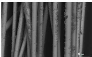
Abb. 79 Kristalline Ausblühungen (DM04\_SEM01\_SE\_20161026)
