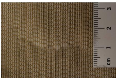
Abb. 41 Aus der Bindung geschobene Glasfaserstränge im Oberstoff
