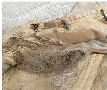
Abb. 43 Ausgefrante Kettfäden des Futterstoffs
