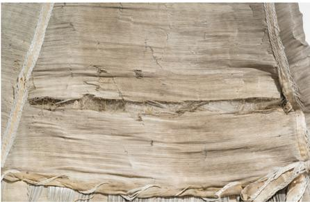
Abb. 37 Fehlstellen im Glasfaser-Seidengewebe
