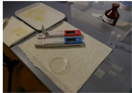
Abb. 3 Geräte zur pH- und Leitfähigkeitsmessung der Reinigungslösungen
