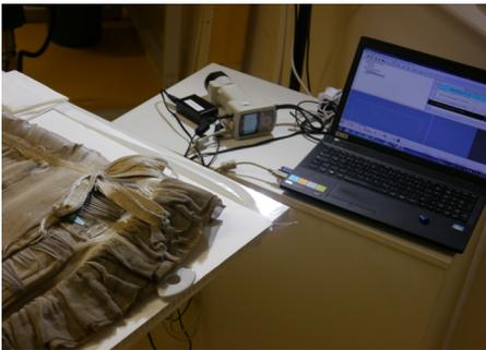
Abb. 4 Farbmessung bei der Durchführung der in-situ Tests am Glasfaserkleid
