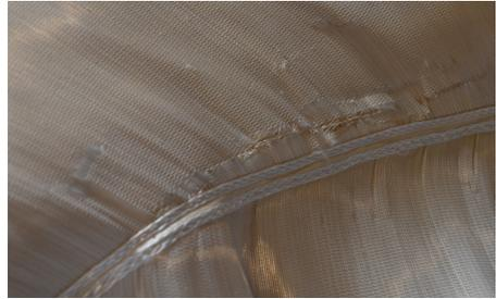
Abb. 58 Bruch und Verlust in Glasfasersträngen im Oberstoff des Rocks
