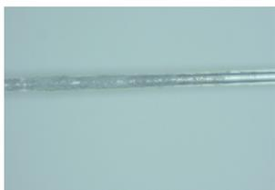
**Abb. 16** Kristalline Ausblühungen (Kleid, NBM03\_LM01\_20x\_AL-POL).
