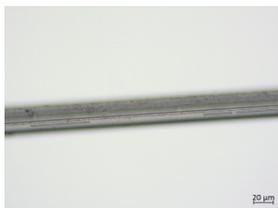
**Abb. 20** Fließstruktur im Glas (Fasern, MAM01\_SEM-BSE\_500x\_20kV).
