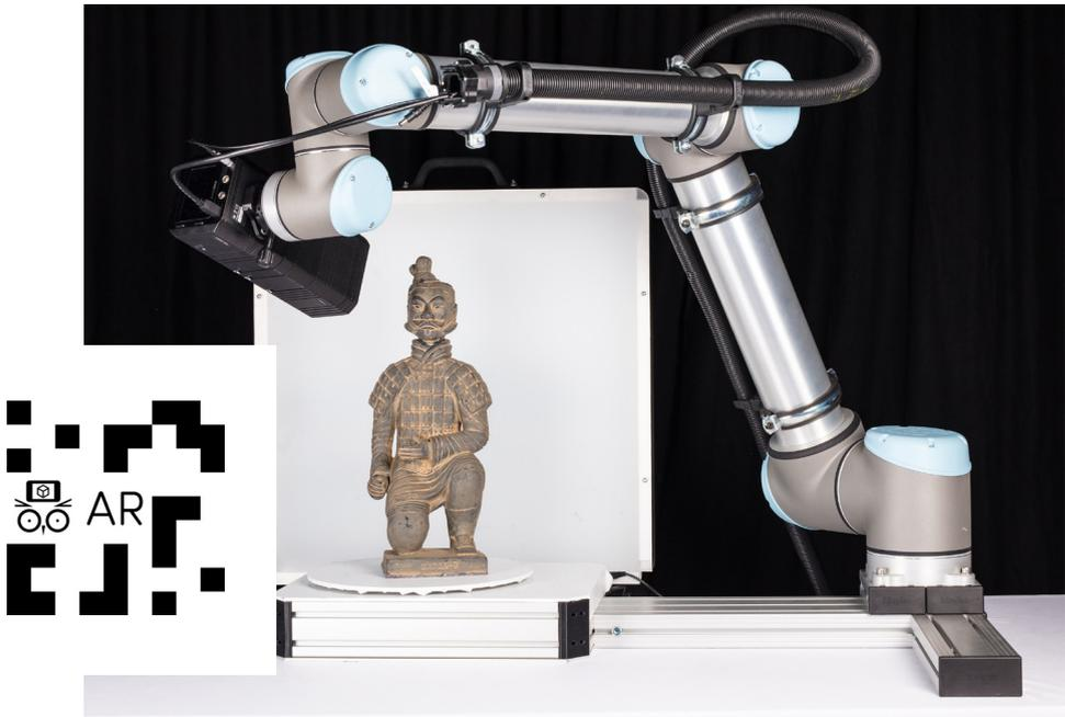
Abb. 1 Roboterscanner CultArm3D-P vom Fraunhofer IGD, Abteilung Digitalisierung von Kulturerbe.
