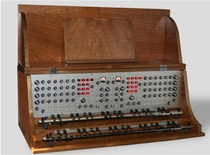
Abb. 10 Das von Jürgen Hiller konzipierte und gebaute Mixturtrautonium nach dem Vorbild Salas.
