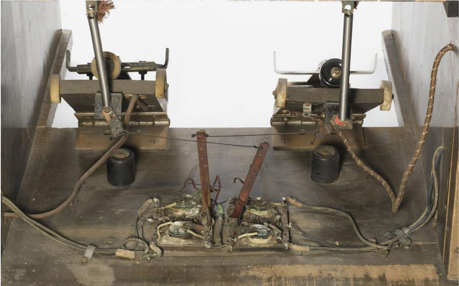
Abb. 46 Die kombinierten Regler der Pedale des Konzerttrautoniums.
