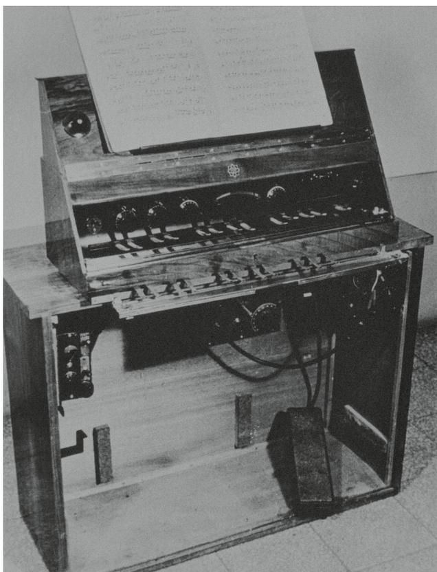
Abb. 19 Das »Konzertinstrument« mit dem Synchronisationszusatz und zweitem Manual.
