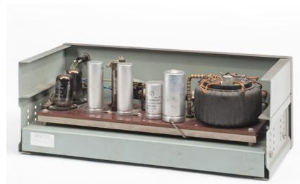
**Abb. 3** Das Innere des Netzgeräts. Es zeigt einen Ringkerntrafo (geringes magnetisches Streufeld) und die im Schaltbild (Abbildung 4) eingezeichneten 12 Watt-Widerstände und die beiden Spannungs-Stabilisator-Röhren ZZ 1040 (links im Bild).
