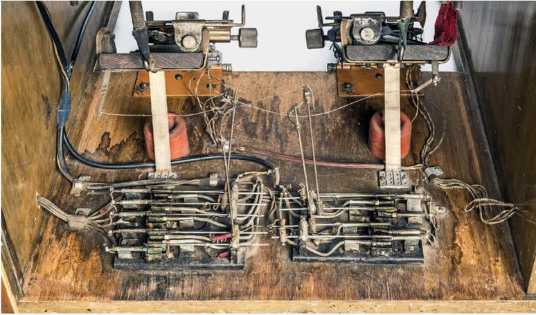
Abb. 54 Die Rückseite der Pedale mit den Flüssigkeitsreglern beim Mixturtrautonium. Die Flüssigkeitswiderstände sind deutlich zu sehen (fünf für den rechten und vier für den linken Fuß), in Gruppen zusammengeschaltet und je Pedal mit zwei Hebeln und Schnurzug betätigt.
