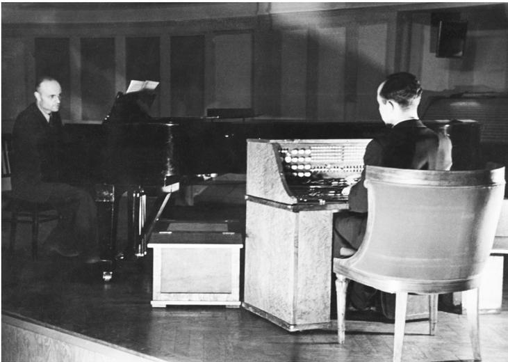
**Abb. 38** Sala am Konzertrautonium, am Flügel begleitet von Harald Genzmer. Neben dem Trautonium stehen das Netzteil (rechts) und ein Lautsprecher (links). Die Aufnahme entstand beim Konzert im Wiener Konzerthaus/Mozartsaal im Jahr 1942.
