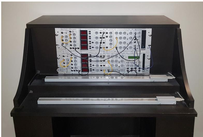
Abb. 9 Modell eines zweimanualigen Mixturtrautoniums mit Döpfer-Modulen nach einer Planung des Autors im Technischen Museum Wien. Das Instrument dient für Vorführungen.
