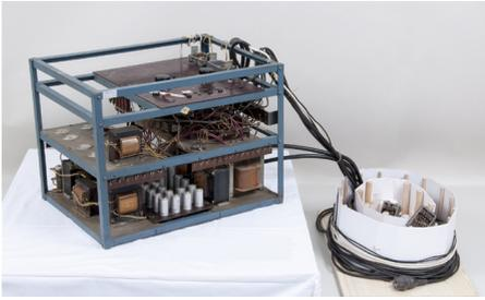
**Abb. 18** Das Netzgerät für das Mixturtrautonium in Salas Nachlass im Deutschen Museum.<sup>20</sup> Auf einem Zettel neben dem Stufenschalter auf der obersten Platte ist die Einschaltreihenfolge vermerkt. Sämtliche Gleichrichterröhren fehlen.
