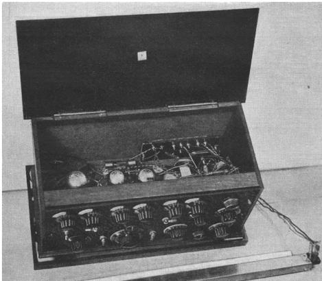
Abb. 3 Einblick in das Innere des Instruments. Die Anzahl der Röhren hat sich gegenüber »RVS 2« deutlich verringert.
