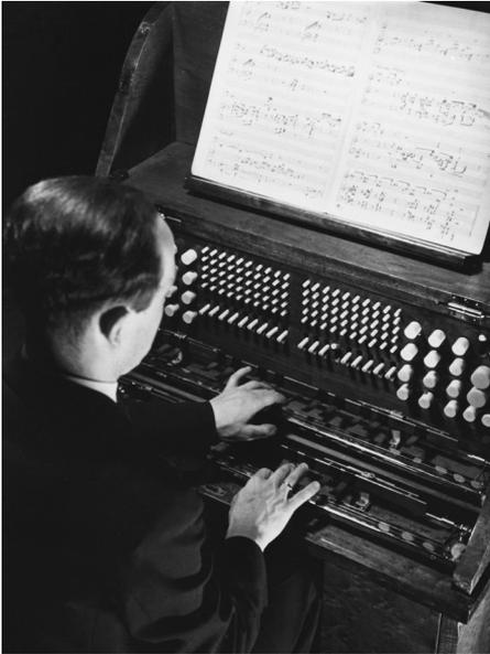
Abb. 40 Das Konzertrautonium in seiner ursprünglichen Form. In der Mitte der Registertafel ist die Reihe von Schaltsteckern zu sehen.
