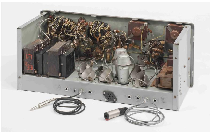
Abb. 74 Innenansicht des Spezial-Klangfarbengeräts.
