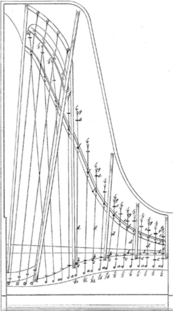
Abb. 28 US-Patentzeichnung zur Duplex-Skala. a: Wirbel; b: Agraffe (»Hauptunterstützungspunkt«); c: »zweite Agraffe«; d: klingende Länge der Saite; e: »Unterlage«; f: äußerer Stegstift; g: Anhangstift.
