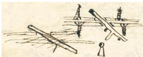
dieses Schloß muß mit einem Uhrschlüssel aufgemacht werden. der Hacken a wird durch eine Feder an der Seite angedrückt daß er in jeder Richtung stehen bleibe
