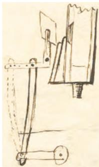
Um eine ganz reine nicht temperirte Stimmung zu erhalten müssen für jede Tonart besondere Register seÿn, wahrscheinlich könne[n] 3 bis 4 Tonarten nach einem Zug gerichtet werden, diese Platten können dicht übereinander liegende Zinn Platten seÿn[,] welche sich immer sämtlich über das obere Ende der Pfeife schieben und dan so viel abgeschnitten werden als die reine Stimmung erfo[r]-der[t].
