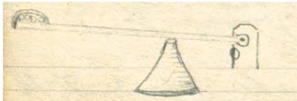
NB dieser Hebel muß nach obiger Zeichnung ungekehrt liegen, so daß der Druck in die Mitte des Balges komt
