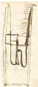
Anstatt daß die Zungen durch eine[n] Keil auf die Kähle [Kehle] gehalten wird. kan dieß durch einen halben Ring, oder Abfall einer Kähle geschehn, welche alsdan einen hohlen Keil vorstellt. Der Wind bläßt daher nicht nur durch die Kähle sondern auch vor derselben durch den hohlen Keil durch das Schallstück hinaus? Die vodere Öffnung dürfte aber nicht sehr groß seyn?
