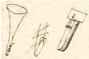
Durch verlängerung der Kehle kan mit einer kurzen Zunge ein tiefer Ton heraus gebracht werden[,] wenn also der Körper mit der Kehle gleichlaufend ist so wird er vermuthlich auch zur Hö[h]e und tiefe des Tones etwas beÿtragen. ohne Zunge muß es dan so aussehen
