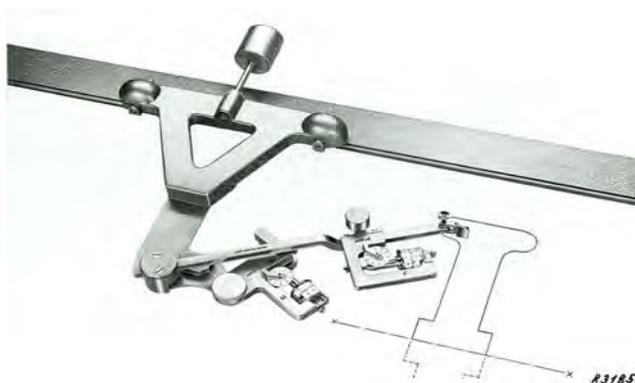
Abb. 12: Kombiniertes Linear-/Linearquadratplanimeter Ott 170, Instr.-Nr. 40548, 1956 (Ott-Bild R31852).
