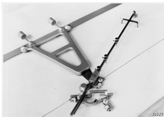
Abb. 27: 3-Rollen-Momentenplanimeter nach Werkmeister; hier: Ott-Bild 35025 (fast identische Abbildung z. B. auch bei Willers, *Maschinen*, 1951, S. 165, Abb. 140).
