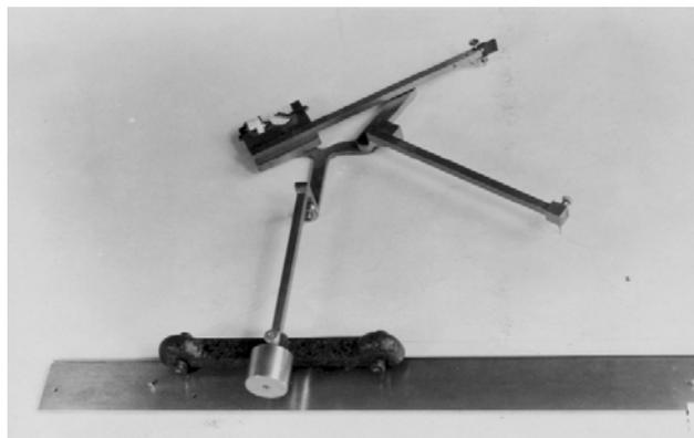
Abb. 14: Versuchsmo­dell II zum Linearquadratwurzelplanimeter Adler-Ott (Ott-Bild, handschriftlich »5.« auf Rs.), d. h. identisch mit dem »universellen« Versuchsmo­dell III zum Linearquadratplanimeter Adler-Ott in der entsprechenden Konfiguration als Linearquadratwurzelplanimeter.
