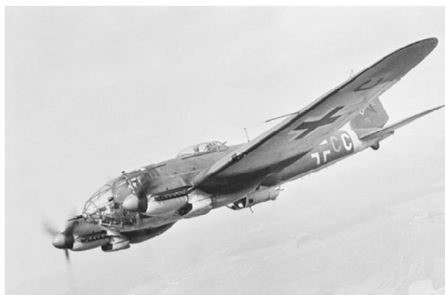
Abb. 3: Die meistgebaute Version war die Baureihe H, angetrieben von zwei Jumo 211-Flugmotoren, die als Basis für den Lizenzbau in Spanien diente.
