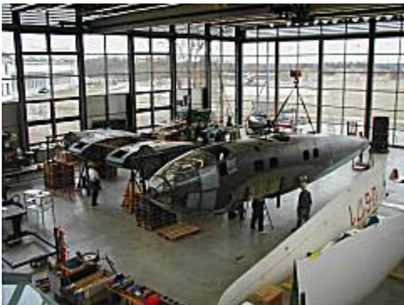
Der Rumpf wird vom Flügelmittelteil abgehoben. Nach Lösen von vier Bolzen lässt sich der Rumpf vom Flügel trennen (Februar 2001).
