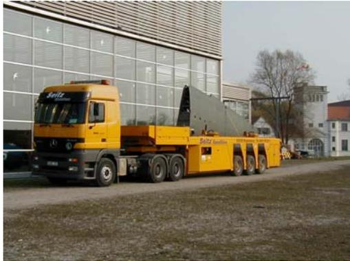
Die Außentragflächen wurden zum Entlacken zur Luftwaffe nach Erding gebracht. Wegen der Abmessungen wurden spezielle Transportfahrzeuge verwendet, die einen senkrechten Transport der Teile ermöglichten (April 2002).
