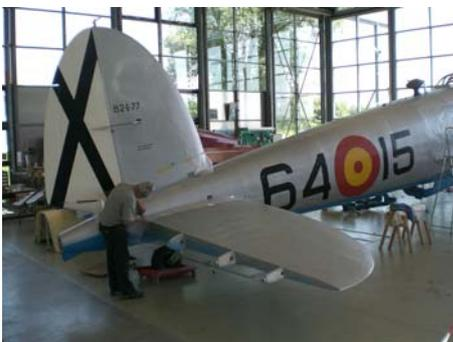
Die Endmontage beginnt. Das Seiten- und das Höhenleitwerk sind montiert.
