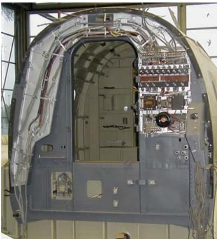
Sehr zeitaufwändig ist die Integration der zahllosen Ausrüstungsteile in die Zelle. Jedes Teil wird gereinigt, restauriert und konserviert. Besondere Sorgfalt ist bei der Elektroinstallation geboten, denn die Isolierung der Leitungen ist brüchig geworden. Das Bild zeigt den restaurierten Kabelbaum am Spant 4, der die Rückwand des Cockpits bildet (November 2004).
