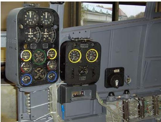
Die vorbereiteten und restaurierten Ausrüstungsteile, Instrumente und Leitungen werden in das Cockpit integriert (Oktober 2007).
