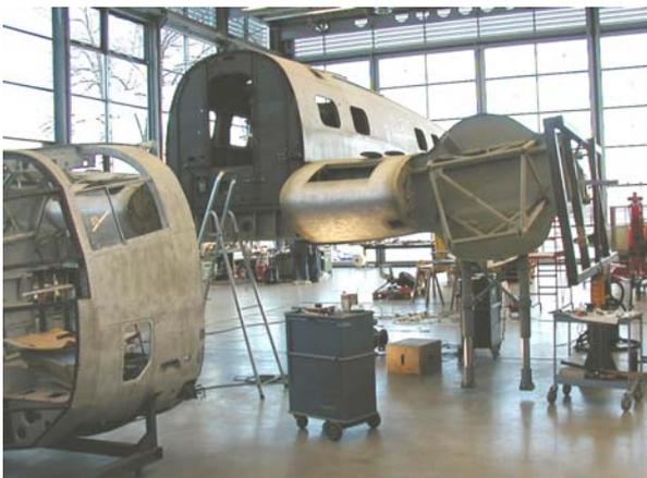
Der Zusammenbau hat begonnen. Der Rumpf ist wieder mit dem Tragflügelmittelteil verbunden, die Federbeine des Fahrwerks sind montiert (Januar 2004).
