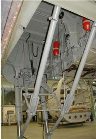
Das wieder eingebaute linke Fahrwerk.
