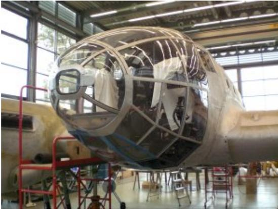
Die fertig verglaste und ausgerüstete Flugzeugführerkabine.
