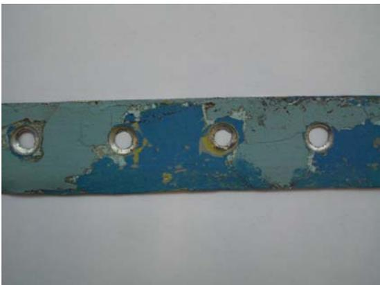
Als Vorlage für den neu aufgetragenen Farbanstrich dienen Farbreste, die erhalten geblieben sind. Dieses Abdeckblech stammt von der Rumpfunterseite und zeigt den originalen azurblauen Farbton, der nach der Außerdienststellung des Flugzeugs für den Film »Luftschlacht um England« hellblau überlackiert wurde.
