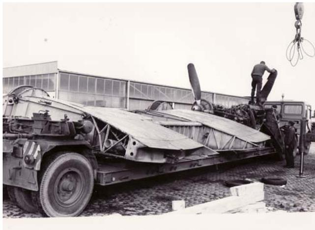
Abb. 11: Transport des Tragflügelmittelteils und der beiden Flugmotoren mit einem Tieflader vom Flugplatz Siegerland zum Fliegerhorst Erding Ende 1977.
