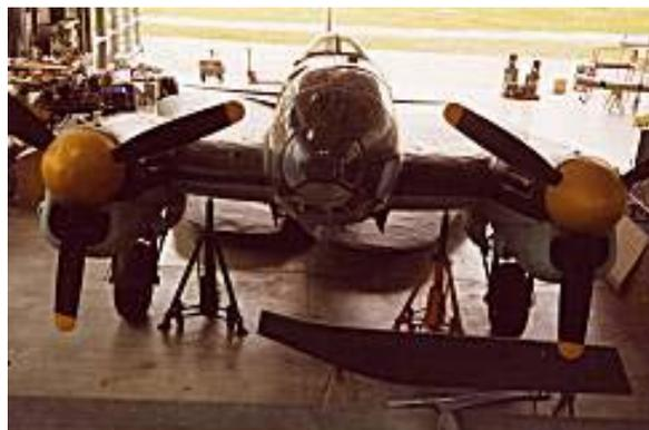
Die Zerlegung des Flugzeugs hat begonnen, die Außenflügel sind bereits demontiert. Aus dieser Perspektive, von der Galerie aus, können die Besucher den Fortgang der Restaurierungsarbeiten verfolgen (September 2000).
