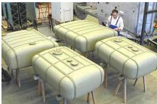
Abb. 9: Die Kraftstofftanks nach der Lackierung. Zwei der Tanks werden in das Flügelmittelteil eingebaut, zwei in die Außenflügel (Februar 2002).
