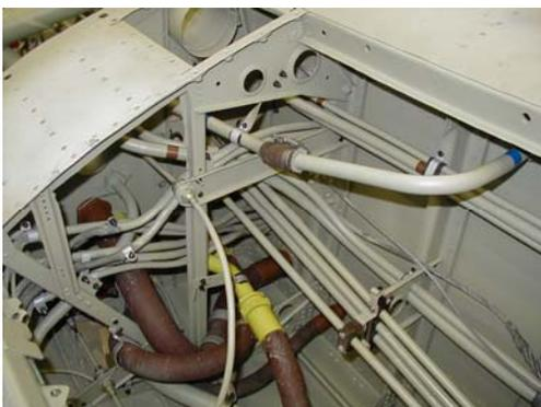
In der Flügelnahe verlaufen auf engstem Raum die Versorgungsleitungen und die Bediengestänge vom Rumpf zum (hier rechten) Triebwerk (November 2004).
