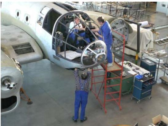
Die Instrumente, der Flugzeugführersitz und die Bedienorgane sind eingebaut. Nun werden die Plexiglas-scheiben eingepasst. Die sphärisch geformten Scheiben werden einzeln über extra angefertigten Formen gezogen (Januar 2008).
