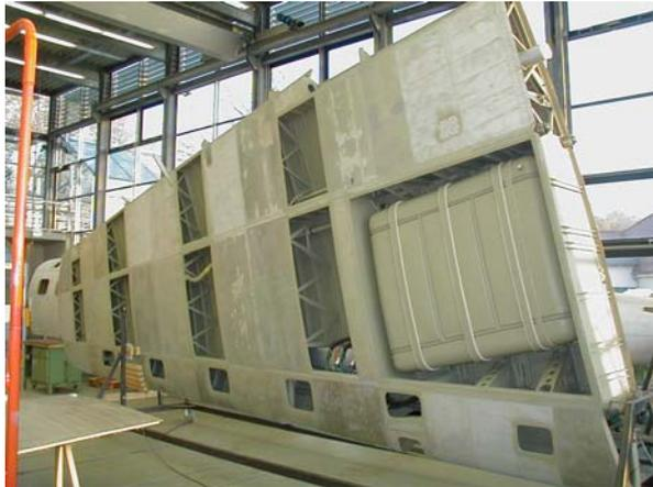
Einbau der Kraftstofftanks in die Außenflügel. Damit sind die Arbeiten, mit Ausnahme der Lackierarbeiten, an den Außenflügeln abgeschlossen (Oktober 2003).
