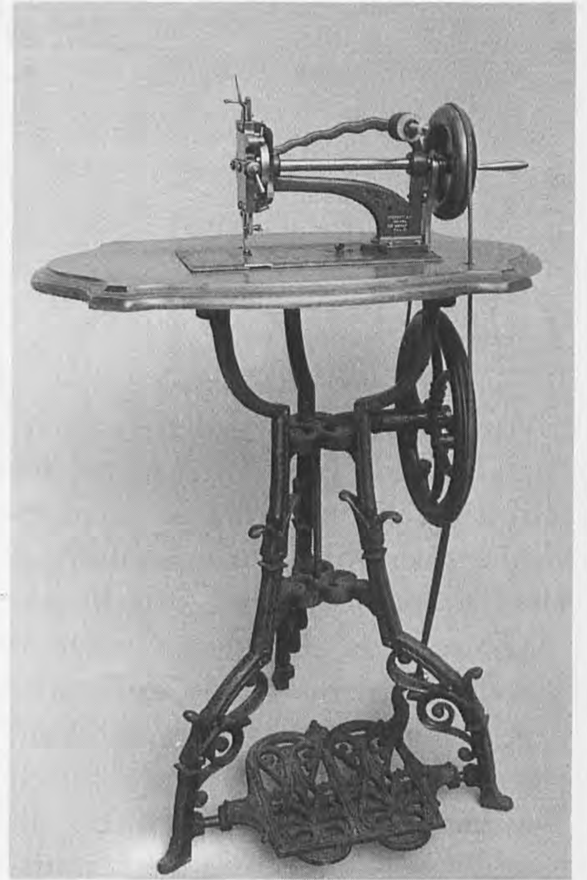
Flachbett-Nähmaschine des Herstellers Gigaroff, um 1864.
