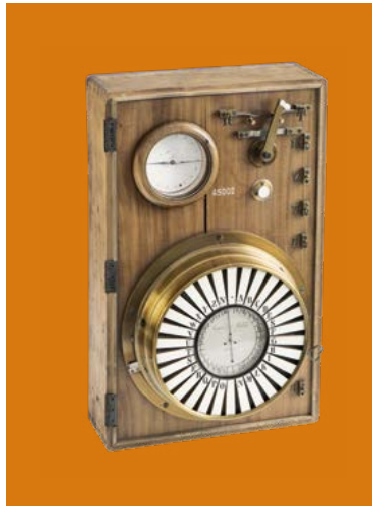
Zeigertelegraf (von Siemens & Halske, Berlin, um 1850) mit einer Tastatur aus Elfenbein.
