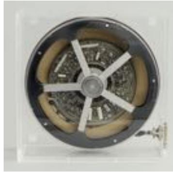
Schwungrad zur Lagestabilisierung aus dem ersten europäischen geostationären Nachrichtensatelliten Symphonie. Das 6,6 kg schwere Schwungrad erreichte eine Drehzahl von 3000 U/min.
