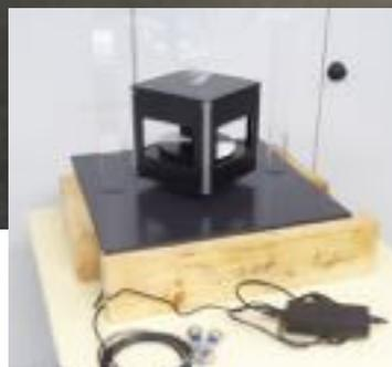
Demonstration zur Satellitensteuerung mit Schwungrädern im Probeaufbau in der Werkstatt.
