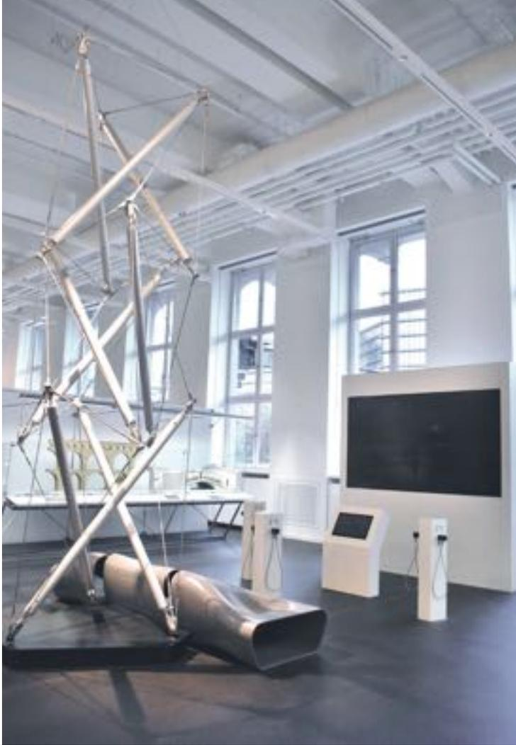
biles Tragwerk ergibt. Der Turm wirkt statisch wie eine konventionelle Fachwerkkonstruktion. Dazu gibt es unmittelbar daneben ein Modell, an dem das Prinzip des Fachwerks erklärt wird.
