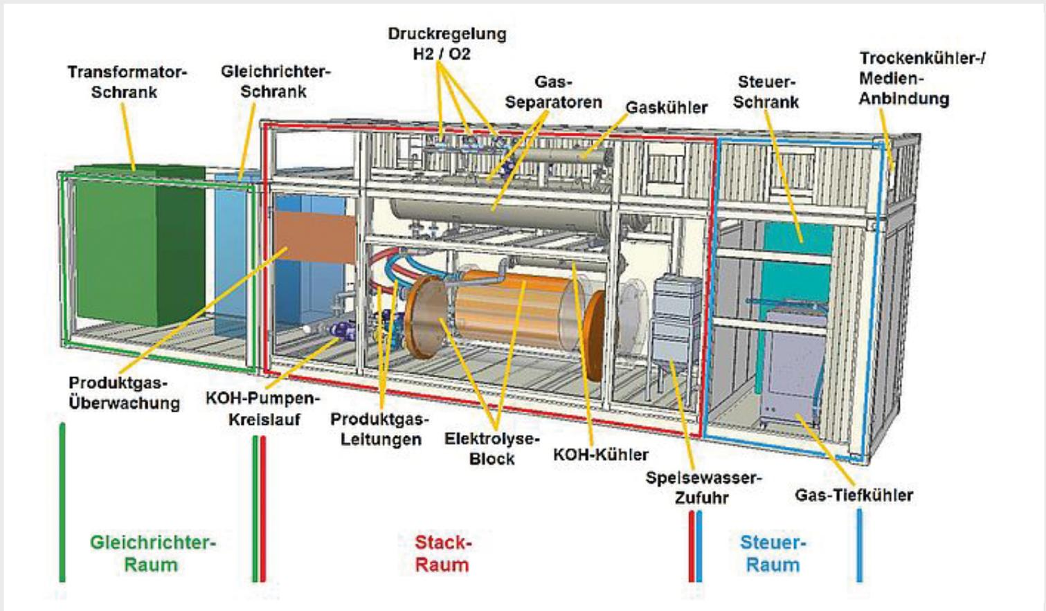
Aufbau eines Forschungselektrolyseurs, mit dessen Hilfe das Potenzial zur Kostensenkung bei der Erzeugung von Wasserstoff ausgelotet werden soll.
