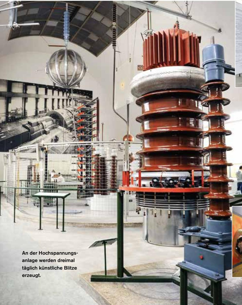
An der Hochspannungsanlage werden dreimal täglich künstliche Blitze erzeugt.
