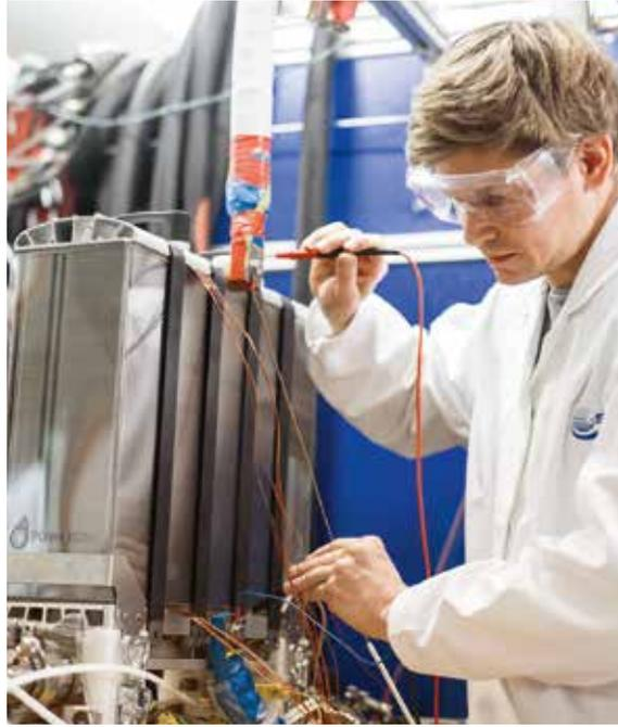
Am Zentrum für Sonnenenergie- und Wasserstoffforschung in Baden-Württemberg arbeiten Wissenschaftler an der Entwicklung von Brennstoffzellen, die künftig in Automobilen eingesetzt werden können. Im Brennstoffzellen-Testzentrum in Ulm werden dazu Belastungstests durchgeführt.
