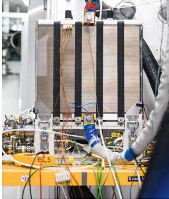
Im Rund-um-die-Uhr-Betrieb wird an einer 100-Kilowatt-Brennstoffzelle eine wöchentliche Fahrleistung von mehr als 5600 Kilometer simuliert.
