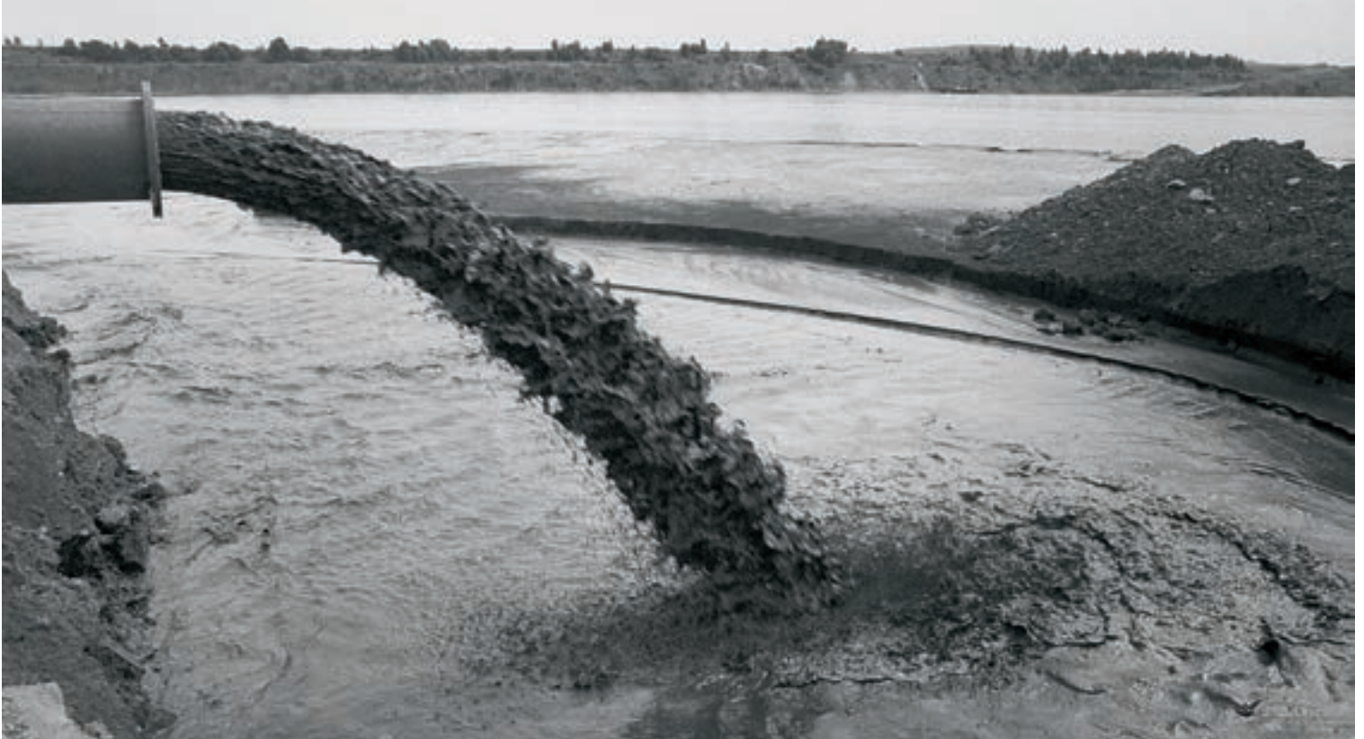
Uran-Schlamm bei Seelingstädt (Thüringen) wird in ein Absetzbecken gepumpt. Solche Becken mussten nach 1990 aufwendig saniert werden.
