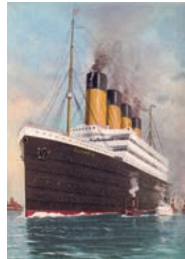
Die Olympic war ein Schwesterschiff der Titanic. Ihre Jungfernfahrt führte sie 1911 von Southampton nach New York. 29 Dampfkessel trieben zwei Vierzylinder-Verbundmaschinen und eine Parsons-Turbine an. Damit erreichte die Olympic eine Höchstgeschwindigkeit von 23 Knoten (43 km/h).
