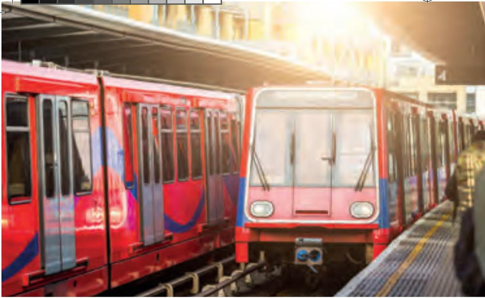
Durch fahrerlose U-Bahnen kann die Taktfrequenz deutlich erhöht werden. Immer mehr Städte (im Bild: London) setzen auf diese automatisch fahrenden Züge. Um die Akzeptanz zu erhöhen fahren vielerorts noch Begleiter zur Kontrolle mit.
