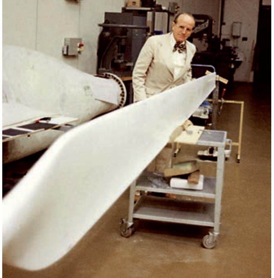
Der Maschinenbauingenieur Ulrich Hütter befürwortete vehement die Leichtbauweise der Rotorblätter aus glasfaserverstärktem Kunststoff für das geplante Riesenwindrad GROWIAN.
