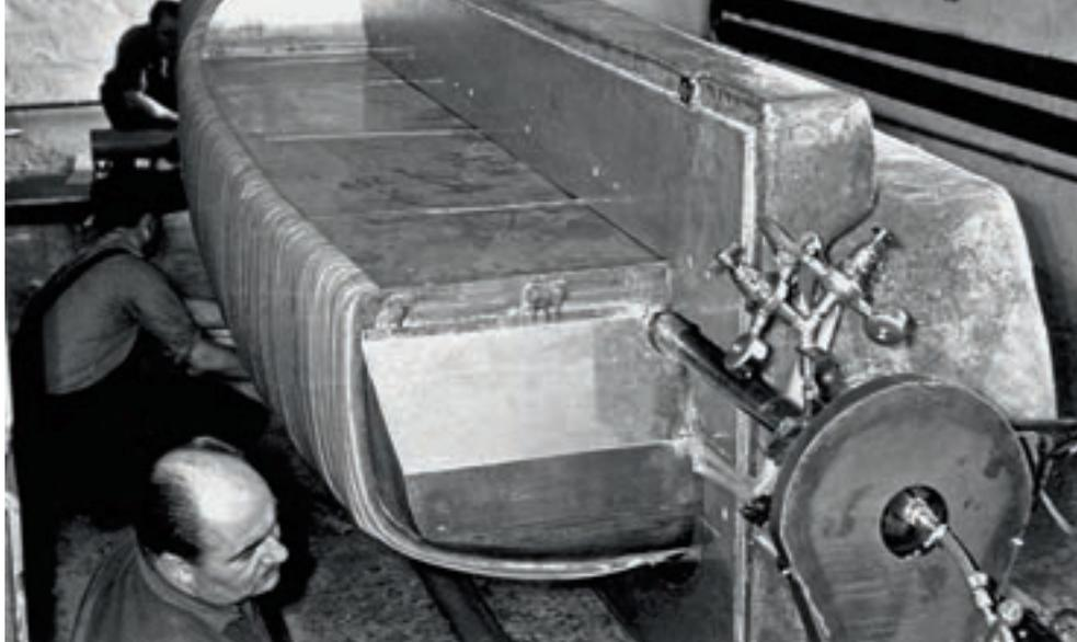
gab es erste Ansätze bis hin zu einem kompletten Schulflugzeugmuster »Timm Tutor«, das 1940 erstmals flog und im »Aeromold«-Verfahren hergestellt wurde. Hierbei handelte es sich um in Kunstharz getränkte Sperrholzplatten, die in Formen gepresst und thermisch ausgehärtet wurden. Das synthetische Harz diente der Verklebung und Imprägnierung, während Holz noch immer die Hauptrolle spielte.
