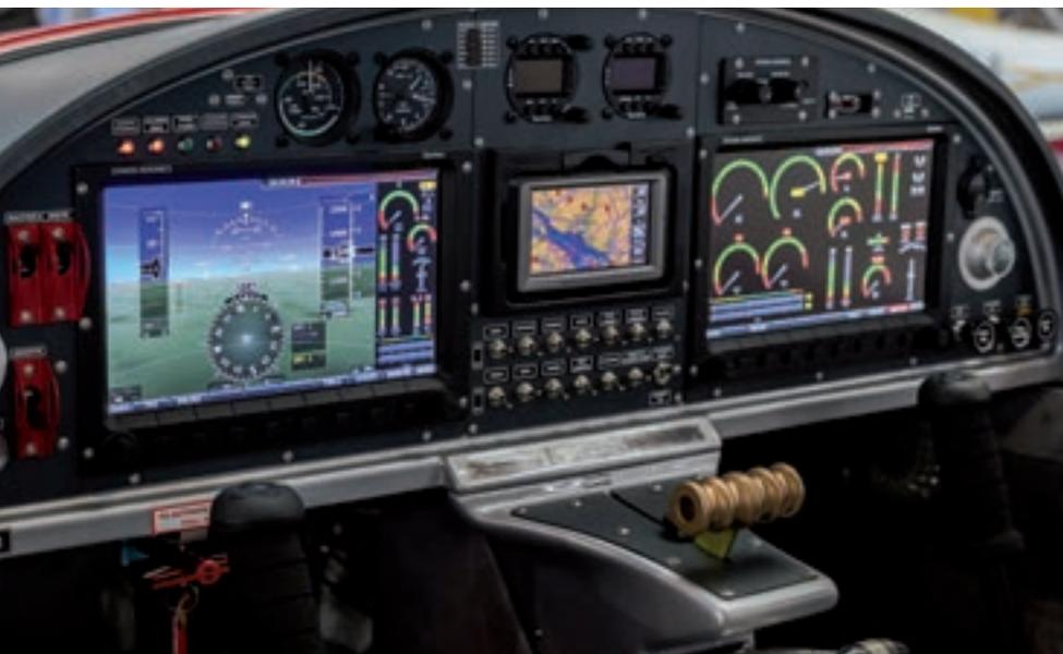
Das Cockpit eines modernen Kleinflugzeugs. Der Pilot wird heute von leistungsfähigen elektronischen Helfern unterstützt. Trotzdem ist beim Sichtflug die Außenwelt die wichtigste Informationsquelle.
