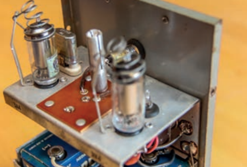
Ein Zweiröhrengerät mit Senderquarz. In der damaligen Zeit die technische Oberklasse der Fernsteuersender.
