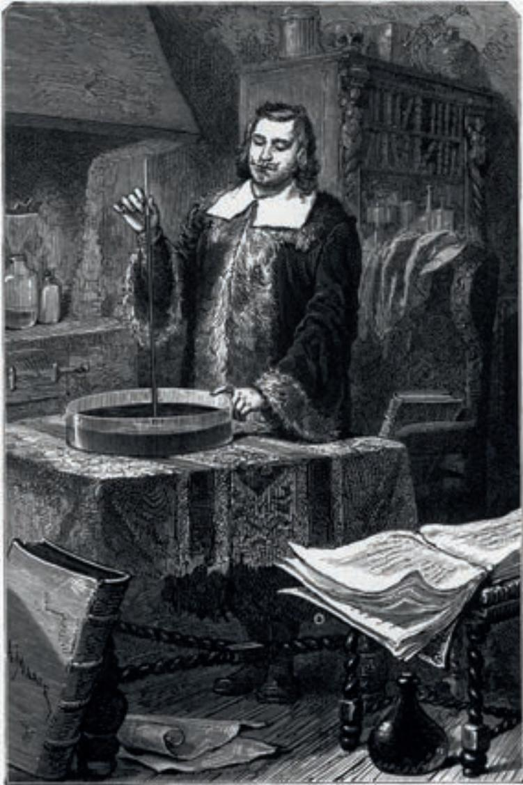
Der italienische Physiker Evangelista Torricelli (1608–1647) konnte zeigen, dass die Flüssigkeit in einer Röhre aufsteigt, solange das Gewicht der Flüssigkeitssäule gleich dem Luftdruck ist, der von außen auf den Flüssigkeitsbehälter drückt. (Zeichnung von Camille Flammarion, London 1873).
