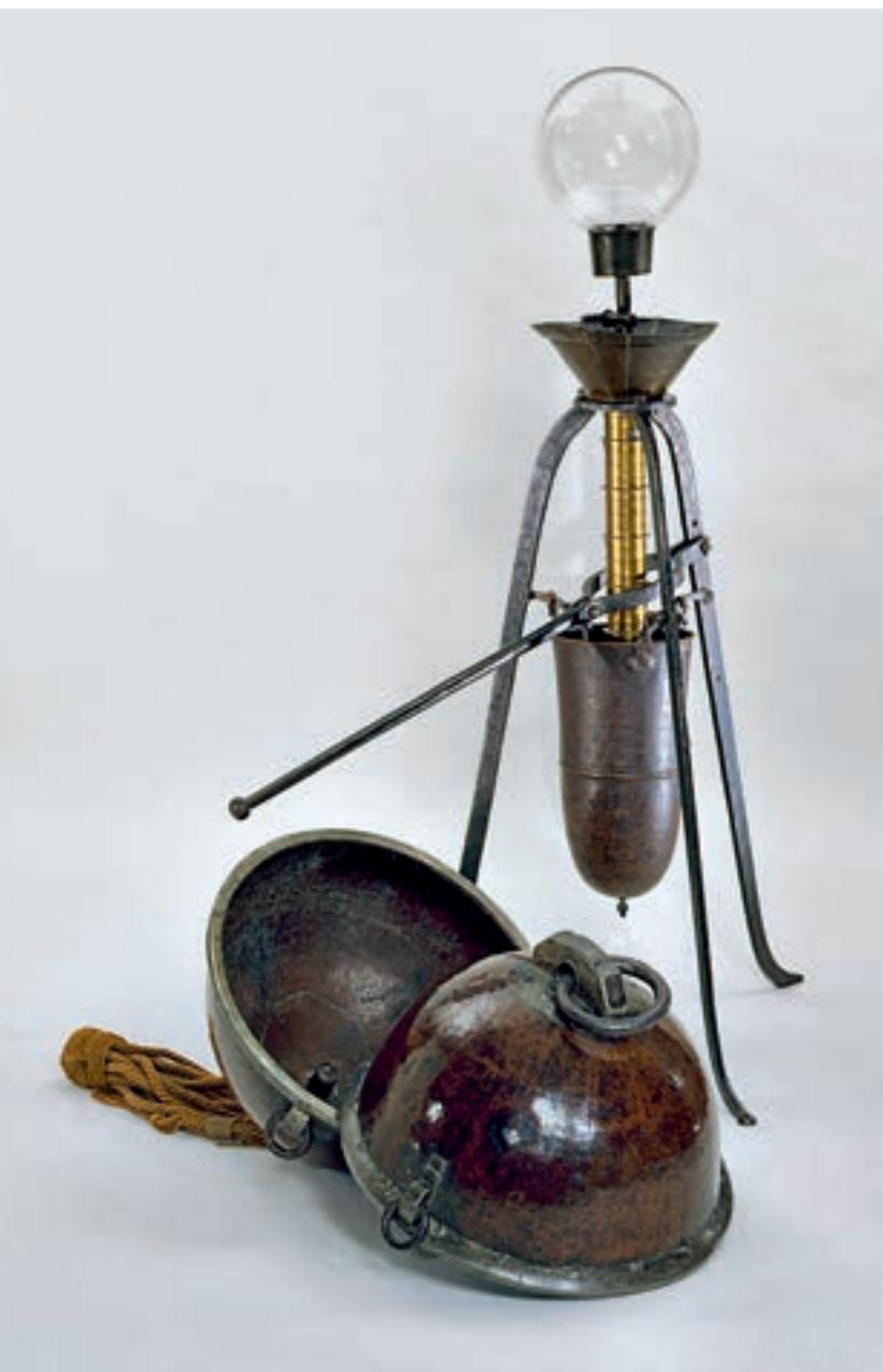
Bild oben: Nicht einmal Pferde können die Magdeburger Halbkugel voneinander trennen. Bild unten: Ein Modell der Halbkugeln und die Luftpumpe (rechts), mit der die Luft aus dem Hohlraum gezogen wird, um das Vakuum zu erzeugen.
