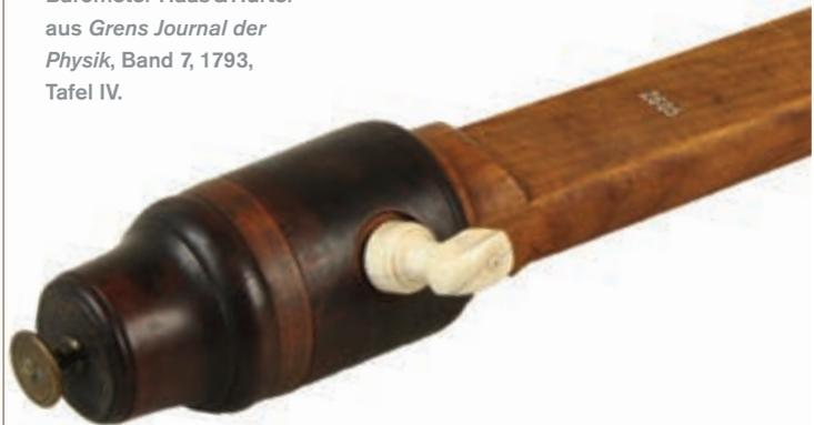
Zwischen 1780 und 1820 entstehen eine Vielzahl unterschiedlicher Reisebarometer und entwickeln sich in einem steten Fortlauf weiter, was sich durch die vielen Veröffentlichungen in den einschlägigen physikalischen Zeitschriften dieser Zeit gut nachvollziehen lässt. Grundsätzlich unterscheidet man zwei Varianten von Reisebarometern: das Heber- und das Gefäßbarometer.
