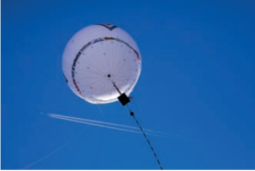
Ein Heliumballon »verankert« bei den »Space Elevator«-Tests der WARR das bis zu hundert Meter lange, senkrechte Seil in der Höhe.
