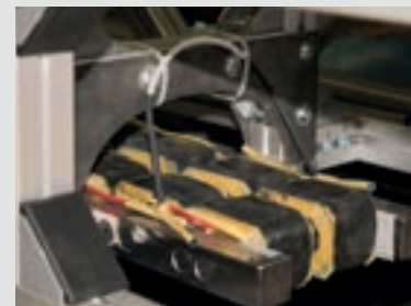
Alles wurde von den Studierenden selbst gebaut oder umgebaut: der Verdichter zum Beispiel und die Wirbelstrombremse für den »Hyperloop«-Pod.
