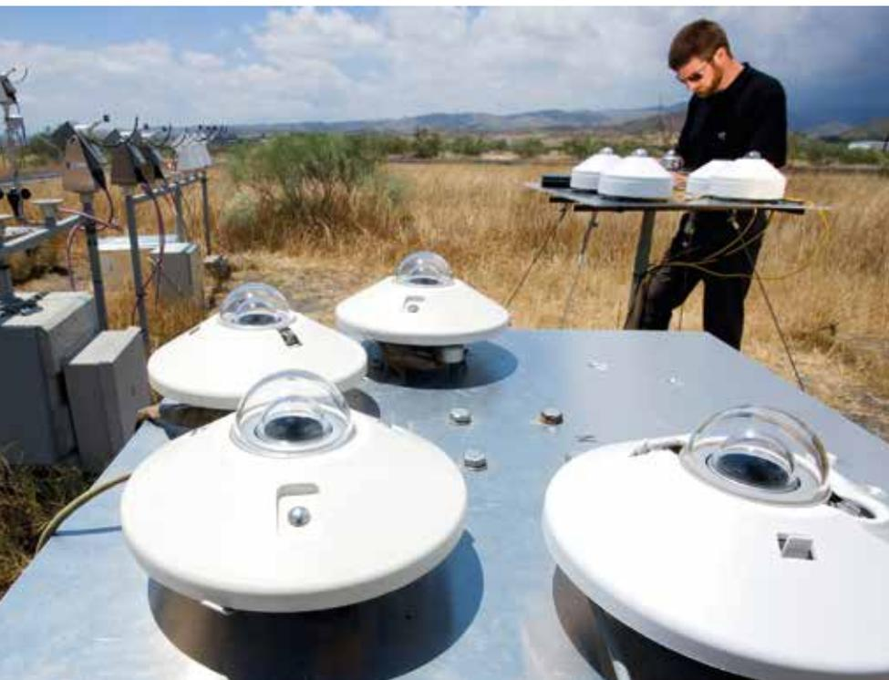
Mit Hilfe eines »Rotating Shadowband Irradiometer« misst ein DLR-Wissenschaftler die direkte Sonnenstrahlung, um herauszufinden, an welchen Orten sich Solartechnik lohnt.
