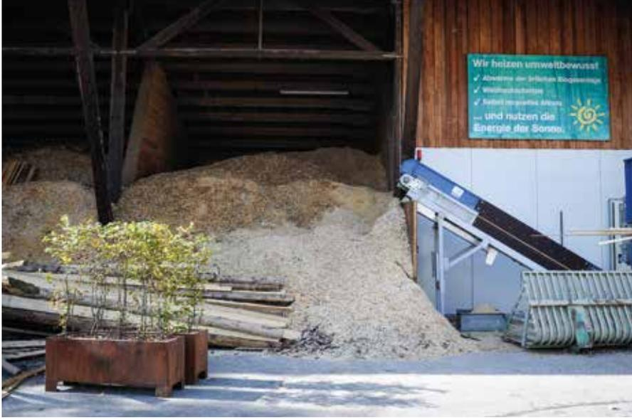
Die Pfanzelt Maschinenbau GmbH verbrennt Waldhackschnitzel und selbst recyceltes Altholz zur Wärmegewinnung.
