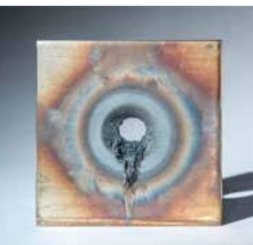
Schon ein 57 m<sup>2</sup> großer Spiegel kann so viel Sonnenlicht auf einen Punkt konzentrieren, dass innerhalb einer Minute ein Loch in Stahl gebrannt wird.
