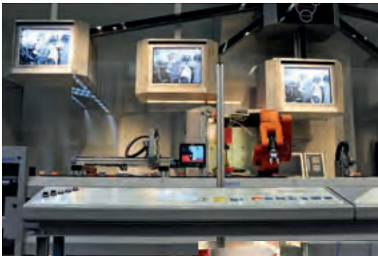
Die automatisierte Fertigungsstraße demonstriert das Potenzial von Computer Integrated Manufacturing (CIM): die Vernetzung von Maschinen und Abläufen zur Optimierung der Produktion.
