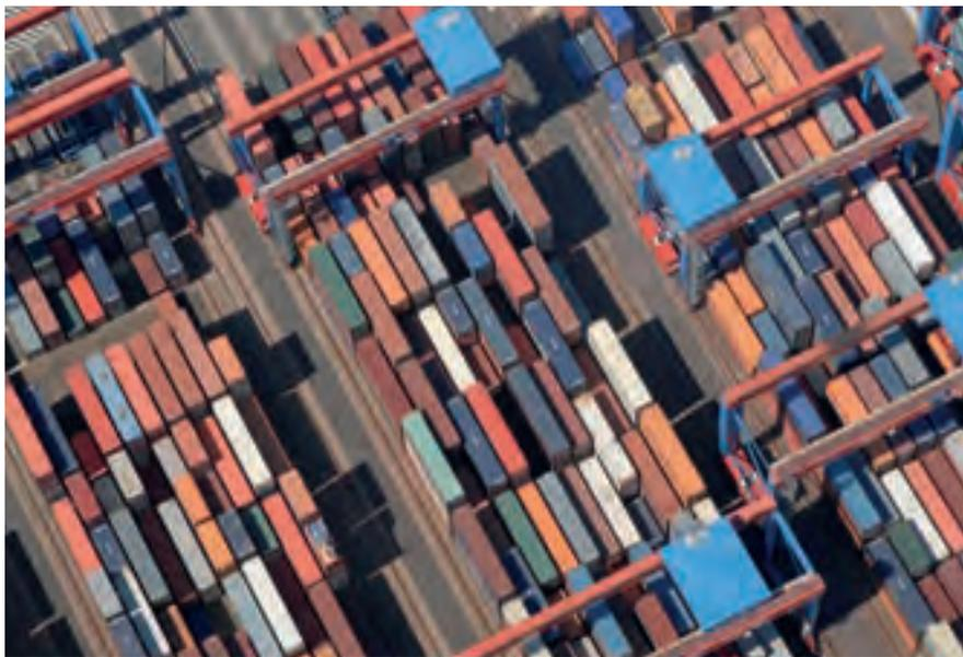
Das gut organisierte Lager ist ein zentrales Element der Logistik. Automatisierte Prozesse ermöglichen die optimale Ausnutzung der Kapazitäten. In Altenwerder sind die Straßen zwischen den Containerlagern menschenleer. Sensoren im Boden steuern autonom fahrende Transporter zuverlässig zum richtigen Zwischenlager.
