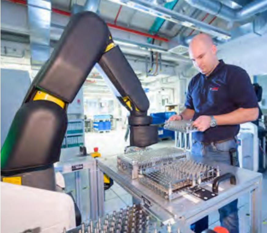
Im Bosch-Werk in Stuttgart-Feuerbach arbeitet ein Mitarbeiter mit einem automatischen Fertigungsassistenten zusammen. Der Roboterarm ist mit einer Sensorhaut überzogen, die einen sich nähernden Menschen erkennt.
