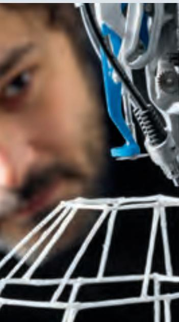
Die luftigen Kokons von Raupen standen Pate für den 3-D-Cocooner der Firma Festo. Aus einer Düse werden harzgetränkte Glasfaserfäden zu stabilen Formen gesponnen.
