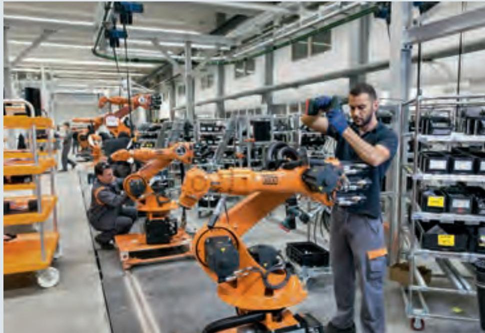
Beim Augsburgener Hersteller Kuka helfen Roboter mit, Roboter zu bauen. Spezielle Leichtbauroboter arbeiten dazu direkt mit den Menschen zusammen.
