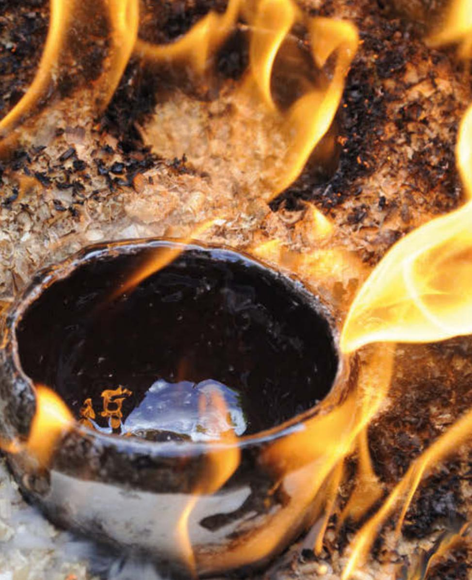
Gebannt wird bei niedrigen Temperaturen in kleinen Öfen. Der Töpfer entnimmt anschließend das glühende Gefäß mit einer Eisenzange aus dem Ofen, um es sofort abzukühlen. Dazu gibt es unterschiedliche Verfahren und Rezepte. Im Westen werden gerne – wie im Bild – Sägespäne oder auch Laub verwendet.
