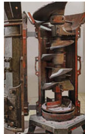
Die Patent-Universal-Ziegelmaschine Carl von Schlickeysens (1824–1909) erobert den Markt und ermöglicht zusammen mit Friedrich Hoffmanns (1818–1900) Ringofen den Übergang zur industriellen Produktion von Ziegeln. (Die Maschine links steht in der Ausstellung Keramik des Deutschen Museums.)
