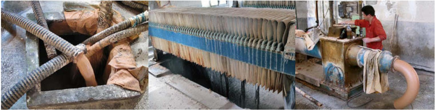
Für die Herstellung von Feinkeramik muss der Ton nach Gewinnung aus der Grube aufbereitet werden. Das Ausgangsmaterial wird von groben Verunreinigungen befreit und dann in mehreren Arbeitsschritten durch Mahlen, Walzen und Schlämmen verfeinert. Die Bilder aus einer chinesischen Fabrik zeigen diesen Vorgang. In Filterpressen (Bild Mitte) wird aus dem aufgeschlämmten Ton das Wasser wieder herausgepresst. Am Ende wird die kompakte Masse in Stücke geschnitten und luftdicht verpackt.
