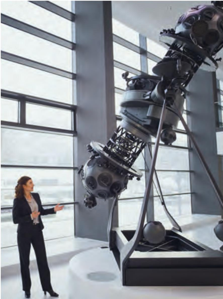
Riesig ist der analoge Projektor aus den 1960er Jahren. Die obere Kugel bildet den Sternenhimmel, der auf der Nordhalbkugel sichtbar ist, ab, die untere Kugel die Sternbilder, die auf der Südhalbkugel zu sehen sind. Die jeweils kleinen Kugeln projizieren Planeten.
