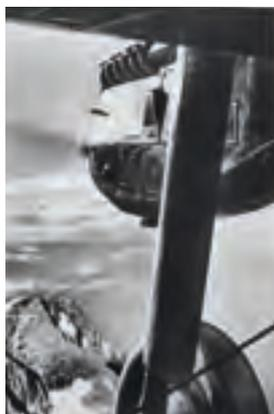
Die ersten Flüge in der Rohrbach Roland fanden mit offenem Cockpit statt. Später allerdings ließ Luft Hansa das Cockpit überdachen, um den Luftwiderstand zu reduzieren.
