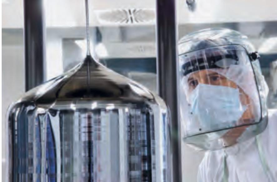
In streng kontrollierten Reinräumen werden heute Halbleiter-Einkristalle gezüchtet, die dann zu kreisrunden Halbleiterplatten, sogenannten Wafers, verarbeitet werden.
