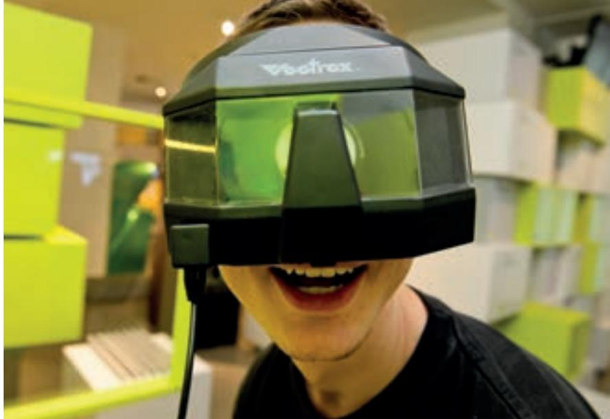
Bild oben: Bei der Spielkonsole Vectrex aus dem Jahr 1982 ermöglicht eine Brille mit mechanischer Lochrasterkarte die 3-D-Wahrnehmung der Vektorgrafik auf dem Bildschirm.
