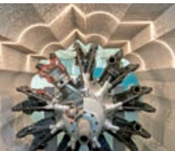
Sternmotoren werden vor allem in der Luftfahrt eingesetzt.
