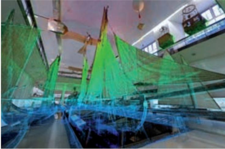
Punktwolke die durch die Laservermessung bei der Kartierung der Ausstellung entsteht.
