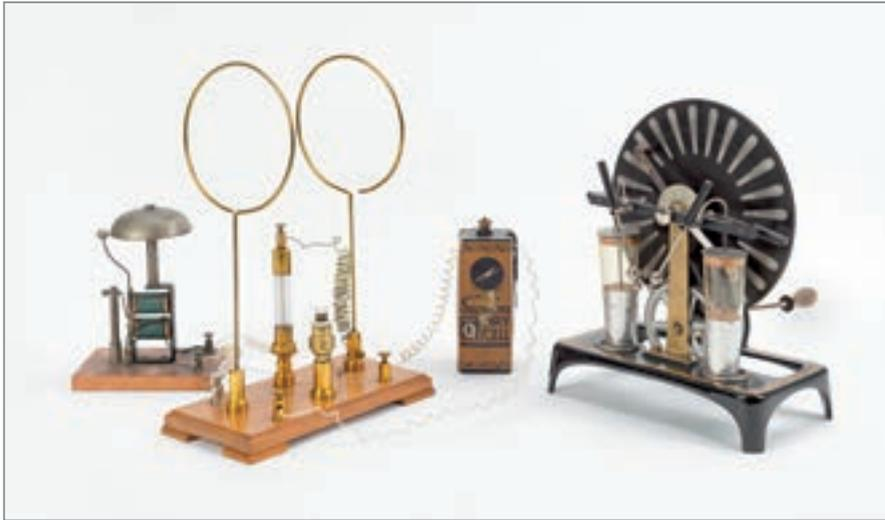
Bild 4 (links): Einfacher Versuchsaufbau, ca. 1911. Von rechts nach links: Influenzmaschine, Kohärenempfänger mit Batterie zur Spannungsversorgung, Antennen, elektrische Glocke.
