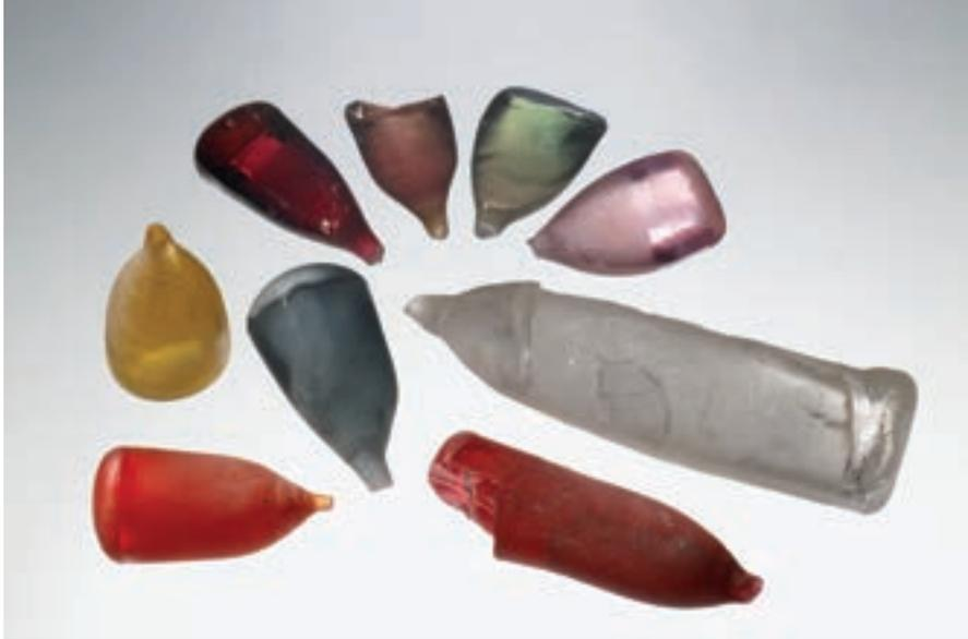
Das Endprodukt des Verneuil-Prozesses ist eine sogenannte Birne eines synthetischen Edelsteins. Aus dieser werden dann Schmucksteine geschliffen oder Lagersteine für technische Zwecke hergestellt.
