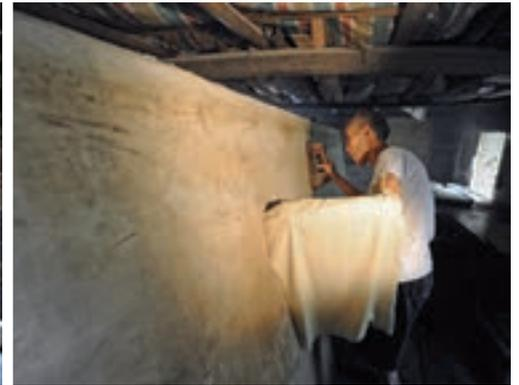
Noch nass werden die Bögen übereinandergelegt. Anschließend hängt man sie zum Trocknen über Stangen.
