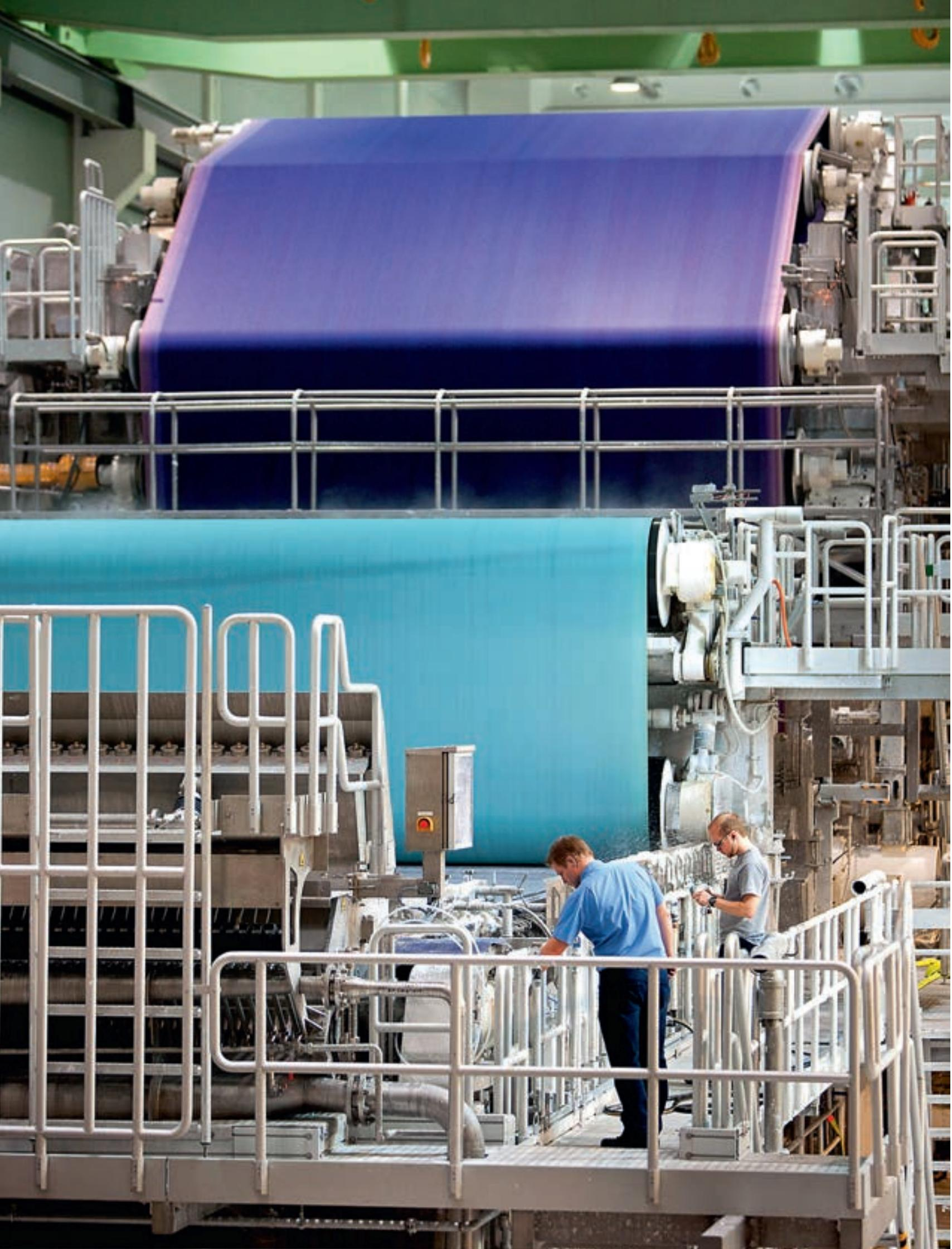
Blick auf den Stoffauflauf mit Siebpartie, grünem Obersieb und Pressenpartie mit violetterm Sieb. In diesem Abschnitt wird das noch nasse Papier entwässert.
