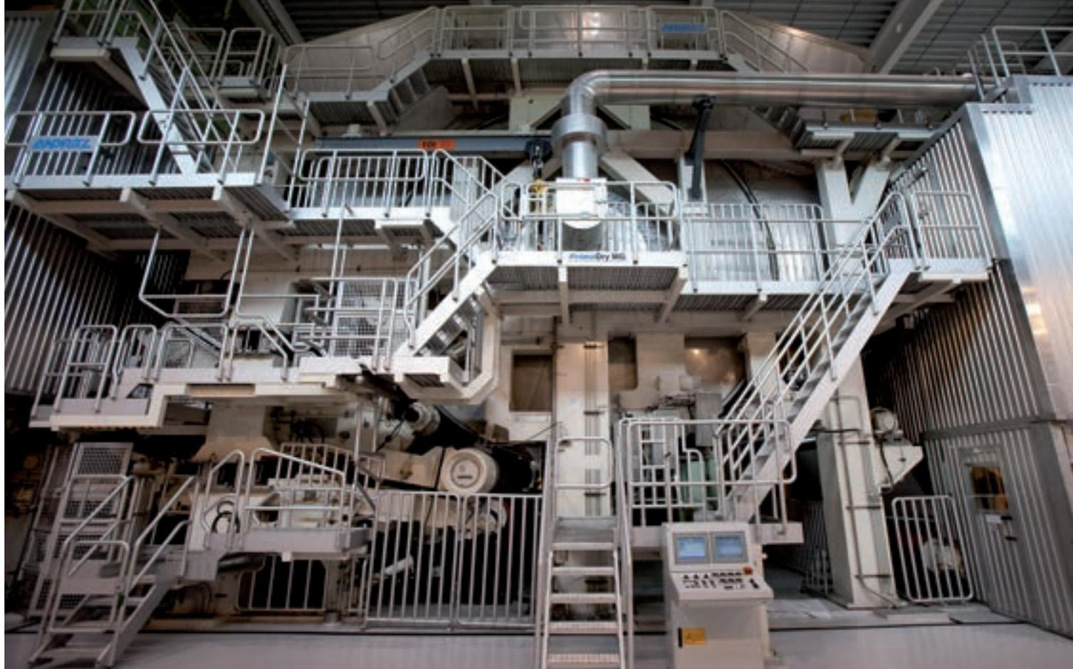
Hinter Stahltreppen und Rohren etwas versteckt befindet sich der Yankee-Zylinder, der weltweit größte Trockenzyylinder. Durch den großen Zylinderdurchmesser und die dadurch sehr lange Verweilzeit einer Papierseite auf der Zylinderoberfläche wird das Papier auf der dem Zylinder zugewandten Seite besonders glatt. Solche »einseitig glatten« Papiere haben eine hohe Festigkeit.
