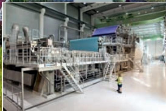
Produktionsanlagen der Zellstoff Pöls AG mit neuer hellgrauer Werkhalle, in der die neue hochmoderne Papiermaschine für gebleichte Kraftpapiere steht.
