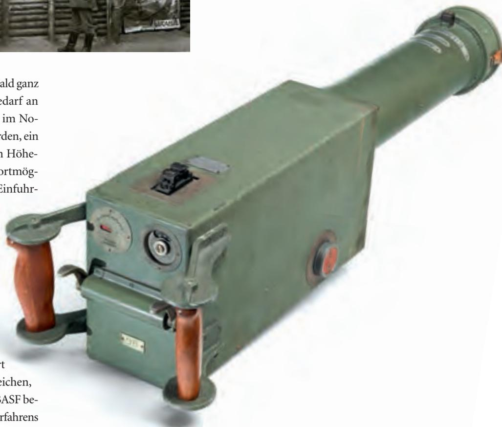
Maschinengewehrkamera der Ernemann AG Dresden, ca. 1916. Die Kamera wurde als Zielübungsgerät in Flugzeugen eingesetzt. Soldaten übten damit das zielgenaue Schießen mit dem Maschinengewehr.
