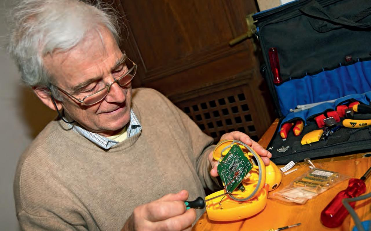
Nach einigen gelösten Schrauben ist das Problem klar: Durch heftiges Drücken des Ausschaltknopfes waren die Kabel der Radio-Ente überdehnt worden.
