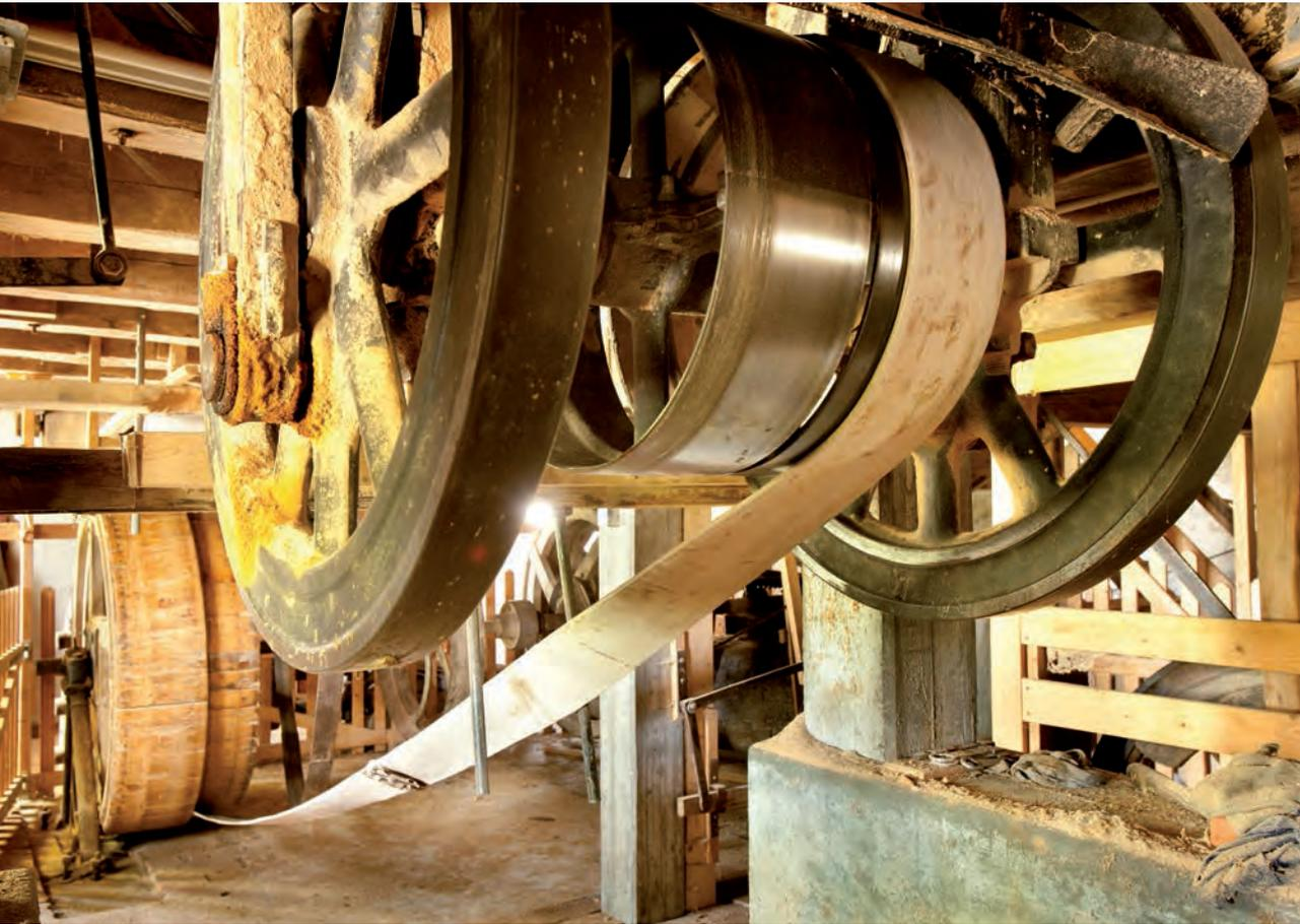
Der »Unterleib« des Vollgatters mit Kurbeltrieb und Riemenscheiben (Fest- und Losscheibe auf gleicher Welle). Im Hintergrund das Treibrad für das Vollgatter auf der Transmission.
