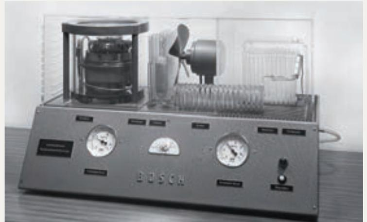
Geräte von Bosch im Deutschen Museum. Bild oben: Verdampfungs-kältemaschine (Lehrmodell einer Kompressionskühlanlage)
