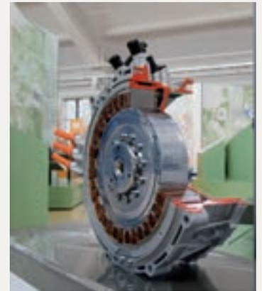
Der integrierte Motorgenerator ist speziell für Hybridfahrzeuge platzsparend gebaut. Er kann deshalb zwischen Verbrennungsmotor und Getriebe platziert werden. Der Motor hat eine Leistung von 34 kW und ein maximales Drehmoment von 300 Nm.
