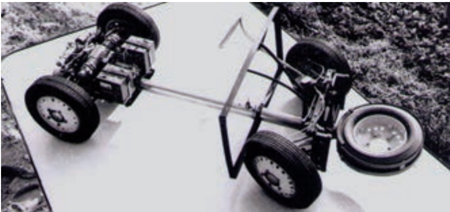
Funktionsmodell M 1:5 »Forschungsauto« mit Heckmotor, Kurbelachse vorn und Zentralrohr wie beim Käfer, jedoch viel fortschrittlicher dank KLR, Mehrlenker-Hinterachse mit elektrischer Niveauregulierung, Dreikreis-Bremssystem, Duo-Grip-Bremse, hydrostatischer Axialkolbenpumpe als Retarder und weiteren technischen Feinissen. Heute im Bestand des Deutschen Museums (Inv.-Nr. L 21/85).
