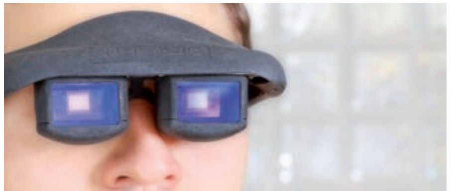
Das Fraunhofer Institut hat diese noch etwas sperrige Datenbrille entwickelt, mit der Anwender Displays allein durch Augenbewegung steuern können.
