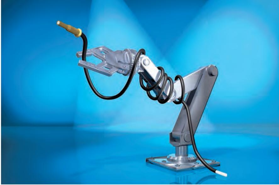
Beim Einsatz von Multifaserbündeln für die Datenübertragung, zum Beispiel von Bildern aus Videokameras, die an Roboterarmen befestigt sind, ist vor allem Flexibilität gefragt. Das ein Millimeter dünne Bündel besteht aus 380 Fasern à 0,05 Millimeter Durchmesser und lässt sich mit einem Radius von fünf Millimetern um Kurven biegen.
