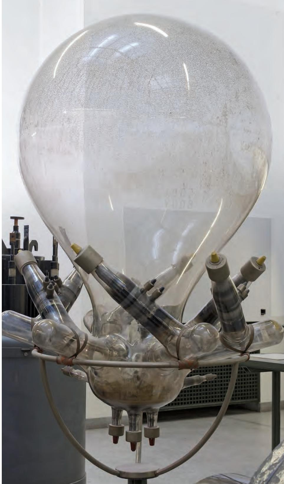
Der Quecksilberdampf-Gleichrichter für elektrische Leistungen bis 600 Volt, 500 Ampère und 300 Kilowatt ist ein zentrales Exponat in der Abteilung »Starkstrom« des Deutschen Museums. Er wurde 1936 von Apparatebauern des Spezialglasunternehmens Jenaer Glaswerk Schott & Gen. für die AEG hergestellt.
