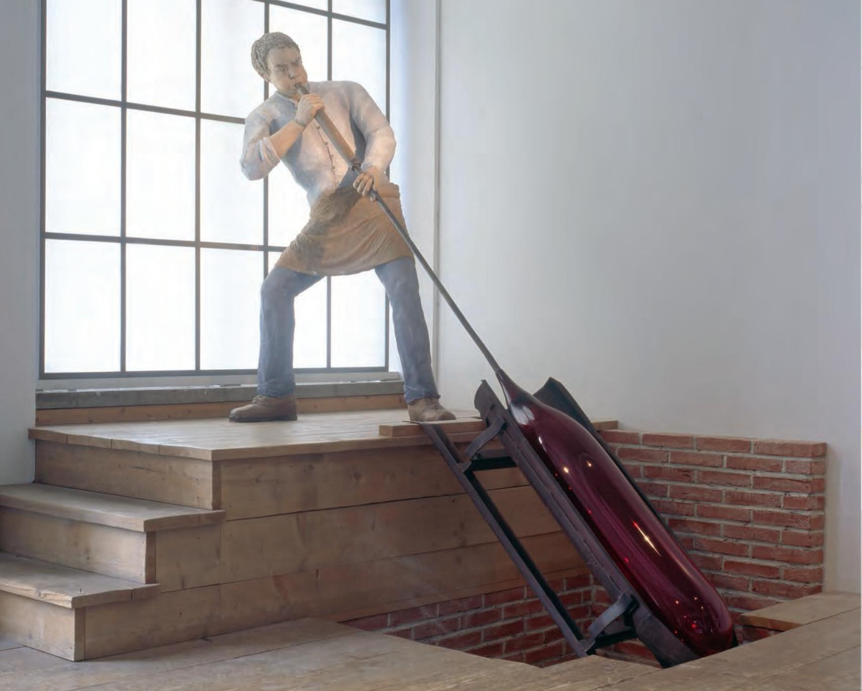
Zur Herstellung von Fensterglas bliesen Glasmacher früher zunächst große, bis zu 25 Kilogramm schwere Hohlformen aus. Nach dem Erkalten wurden die Endkappen abgesprengt und die Zylinderwand der Länge nach aufgeschnitten. Durch erneutes Erwärmen wurde die Zylinderwand weich und ließ sich zur rechteckigen Fläche ausbreiten.
