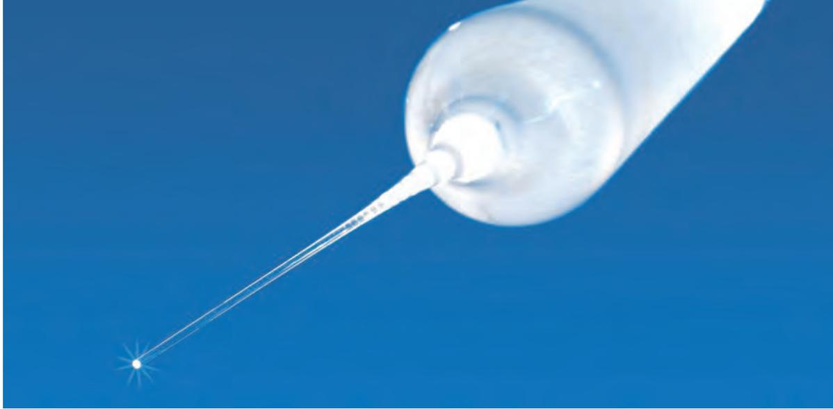
Der Glasstab, bestehend aus Kern und Mantel, dient als Vorform einer Quarzglasfaser. Für die Fertigung wird die Vorform mit der Spitze nach unten aufgehängt und erwärmt, bis das Glas schmilzt.
