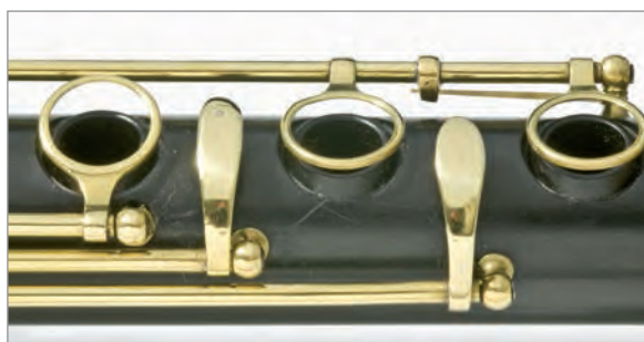
Das neue Griffsystem der Ringklappenflöte ermöglichte es, mit neun Fingern vierzehn Löcher zu schließen. Die feine Ausführung und mechanische Akuratesse dokumentierten Böhms Erfahrung als Goldschmied.
