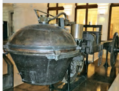
Cugnot-Lastkarren (fardier) 1770 mit Kessel und Zweizylinder-Dampfmaschine vor dem einzelnen Vorderrad. Die Plattform war für den Transport von Munition vorgesehen. Das Original steht in Paris.
