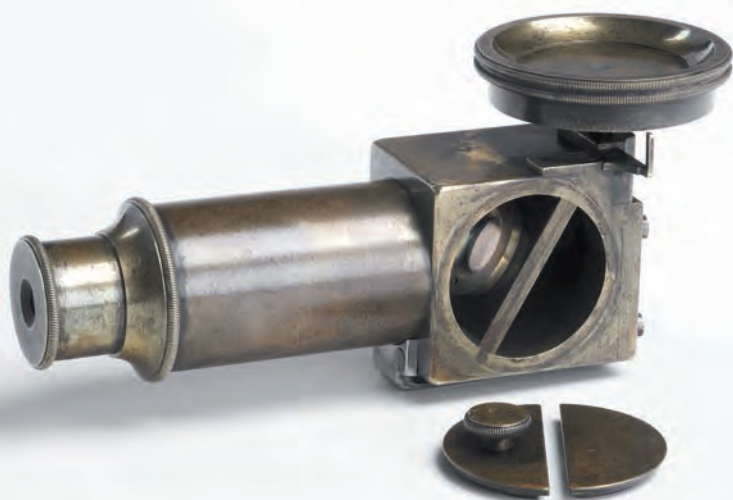
Spätere Form (1853) des Steinheilschen Refraktometers, Original aus den Beständen des Deutschen Museums. Im Rohr befindet sich ein Mikroskop-Okular mit 12-facher Vergrößerung. Das Messprinzip wird auf Seite 41 beschrieben.
