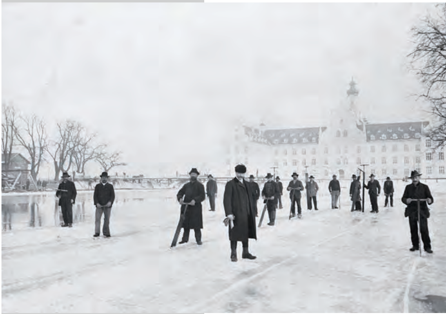
Vor Erfindung der Kältemaschine durch Carl von Linde (1871) schickten Münchner Brauereien im Winter Arbeiter zur Gewinnung von Natureis an den Nymphenburger Kanal. Mit großen Sägen wurden die Eisplatten herausgeschnitten.
