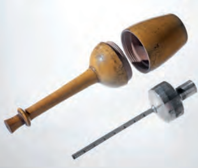
Mit Hilfe der Senkspindel (Aräometer) kann die Dichte von Flüssigkeiten gemessen werden. Sie wird auch als »Bierwaage« bezeichnet. Das oben gezeigte Exemplar aus dem 19. Jahrhundert stammt aus den Beständen des Deutschen Museums.
