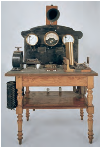
1925: Im unten abgebildeten Funkraum eines Reichsbahnfährschiffs von 1925 befinden sich rechts neben der Lampe eine Löschfunkenstrecke, links oben eine variable Spule und ein Kondensator als Schwingkreis. Obwohl die Anlage auch für Telefonie geeignet war, beschränkte man sich vornehmlich auf die einfachere und preiswertere Telegrafie.
