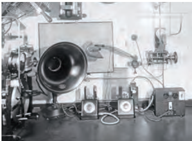
1925: Im unten abgebildeten Funkraum eines Reichsbahnfährschiffs von 1925 befinden sich rechts neben der Lampe eine Löschfunkenstrecke, links oben eine variable Spule und ein Kondensator als Schwingkreis. Obwohl die Anlage auch für Telefonie geeignet war, beschränkte man sich vornehmlich auf die einfachere und preiswertere Telegrafie.
