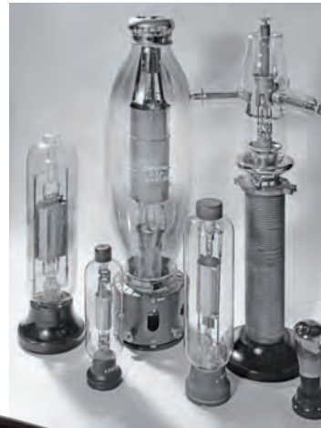
1921–34: Die Entwicklung der Senderöhren, die hier an Exemplaren von 1920 bis 1935 gezeigt ist, begann um 1910 und wurde durch den Bedarf während des Ersten Weltkriegs befördert. Anschließend wurden derartige Röhren vornehmlich für den Rundfunk eingesetzt. Das fast trägheitslose Bauelement Elektronenröhre wurde zum Synonym für Elektronik.
