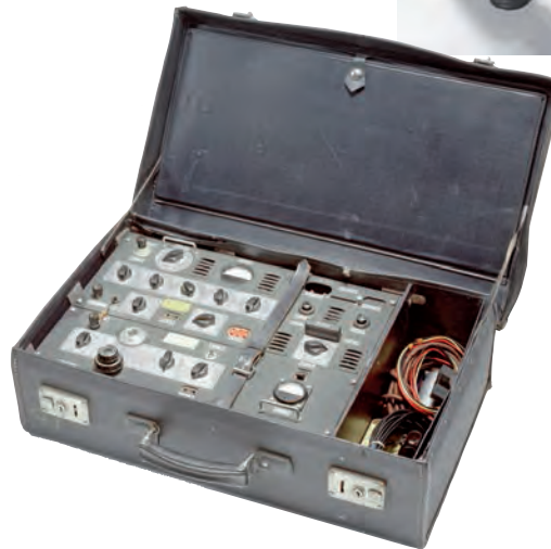
1940: Für den mobilen Einsatz während des Zweiten Weltkriegs stellte Telefunken Agentenkoffer her. Sie arbeiteten auf Kurzwellen und meist als Telegraf. Um nicht geortet zu werden, mussten die Agenten ihre Antenne nach dem Funkkontakt möglichst schnell wieder abkleben.
