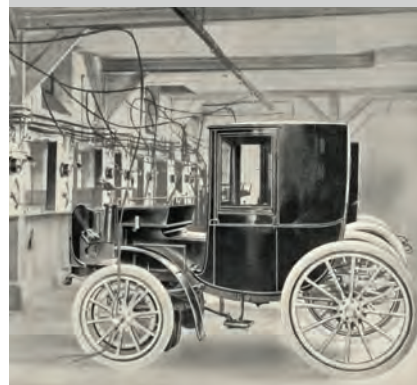
Krieger-Coupés beim Aufladen der Batterien in Paris 1898. Je ein E-Motor mit Rekuperation pro Vorderrad, unter der Vorderachse montiert.
