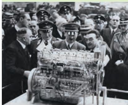
Der »Kristall«-Motor der Firma Bauer & Schaurte auf der Berliner Automobilausstellung von 1938 demonstrierte die Leistungsfähigkeit der neuen, wesentlich leichteren Schrauben.
