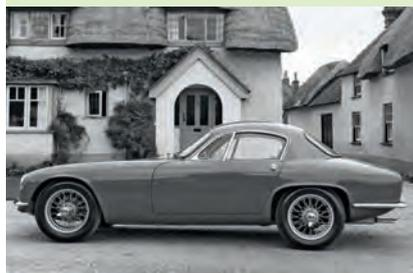
Lotus Elite (1957–63) mit selbsttragender GFK-Karosserie. Ein vorn im Dach eingeklebtes Stahlrohr erhöht die Steife von Dach, A-Säule und Spritzwand. Ein unsichtbar im Vorderwagen eingeklebter Flachstahl-Hilfsrahmen trägt Motor und Radaufhängung.
