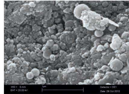
Abb. 3: Ein vergrößerter Ausschnitt aus Abb. 2 zeigt, wie eine dichte Schicht aus Kristallen die Metalloberfläche überzieht.
