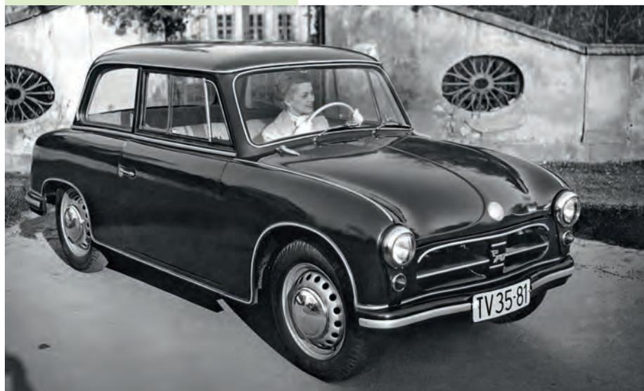
**P70-Limousine (1955–59) mit einem Karosserieskelett aus Stahlblech und mit Außenhautformteilen aus Kunststoff, einem Verbund aus PVC mit Holzfaserverstärkung.**
