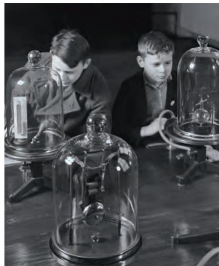
Ein Lieblingsversuch von Wolfgang Kaiser: Per Knopfdruck entsteht in den Glasglocken ein Vakuum und der Ton der Klingel verstummt. Die Aufnahme stammt aus der Zeit um 1945.
