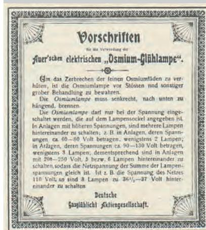
Die nach dem von Auer von Welsbach entwickelten Verfahren gefertigten Metalldrahtlampen waren noch sehr fragil, wie eine Betriebsanleitung aus der Anfangszeit zeigt.
