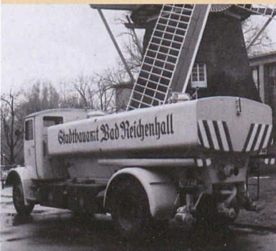
Bergmann-Sprengwagen 1939 mit 11-kW-Hauptstrommotor vor Hinterachse und Akkumulatoren in je zwei Trögen pro Seite. Fahrzeug des Deutschen Museums (zurzeit Deutsches Technikmuseum Berlin).
