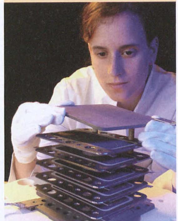
Eine 5-kW-Hochtemperatur-Brennstoffzelle (SOFC) soll künftig die Lichtmaschine im Auto ersetzen. Das bislang hohe Gewicht des Brennstoffzellen-Stapels (Stack) konnte hier durch eine neue Leichtbauweise entscheidend verringert werden.
