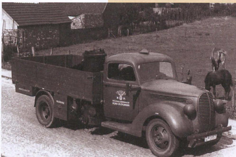
Der Imbert-Holzgasgenerator war bei diesem Ford-V8-Pritschenwagen wie damals üblich rechts hinter dem Fahrerhaus eingebaut worden. Die Holzkohle befand sich im Kasten daneben, der Absitzbehälter war unter Stoßstange angebracht. (Foto um 1942)
