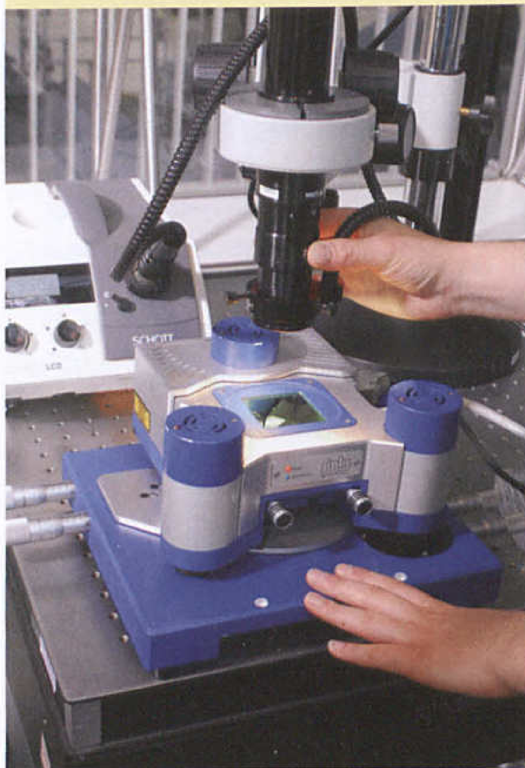
Das Rasterkraftmikroskop im Gläsernen Forscherlabor des Deutschen Museums wird für eine Aufnahme vorbereitet.
