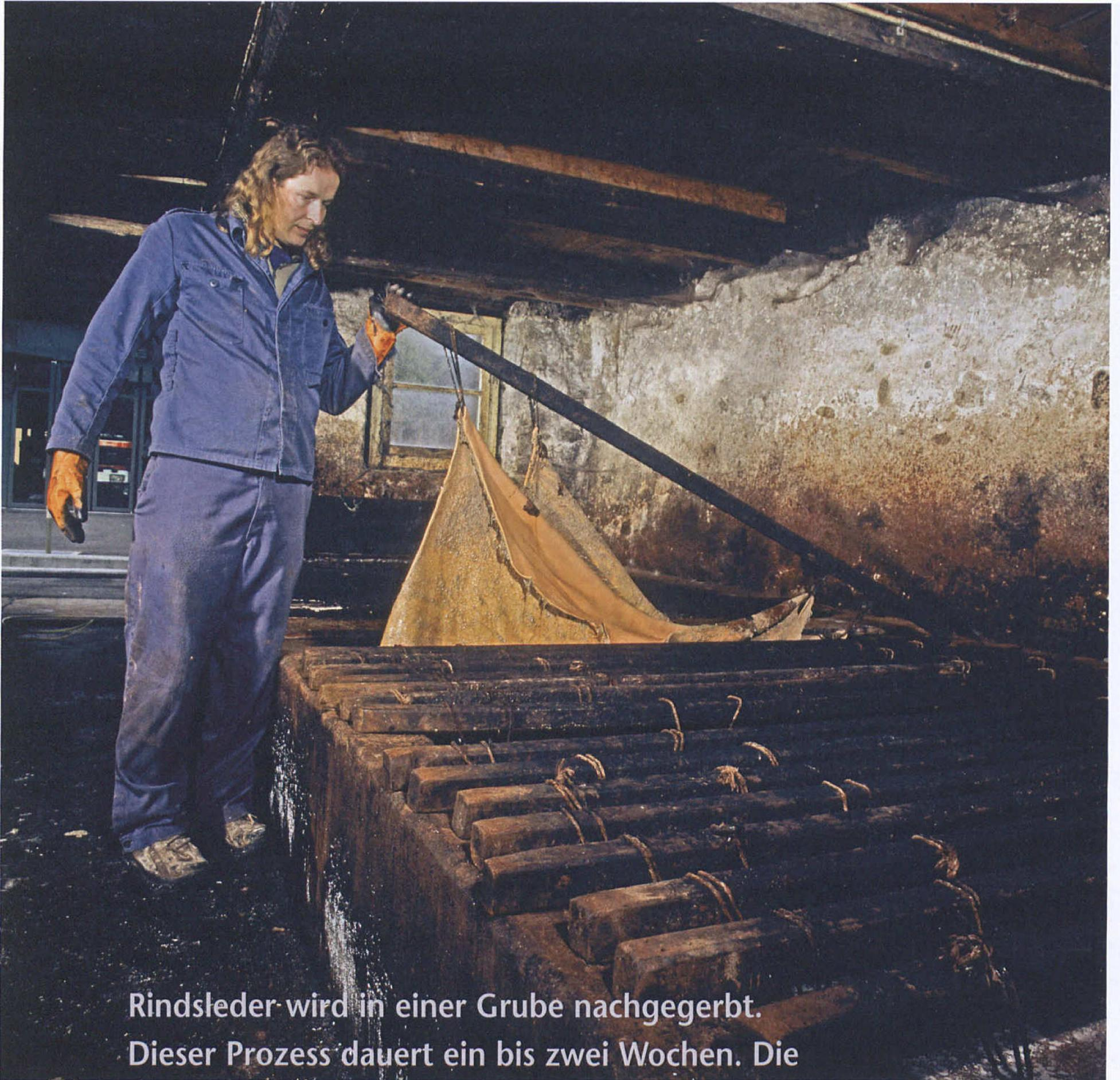
Rindsleder wird in einer Grube nachgerärbt. Dieser Prozess dauert ein bis zwei Wochen. Die Häute werden schichtweise mit Eichenrinde bedeckt. Am Ende wird verdünnter Rindenextrakt darüber gegossen. Erst wenn ein Querschnitt zeigt, dass das Leder durchgehend braun gefärbt ist, ist dieser Vorgang abgeschlossen.
