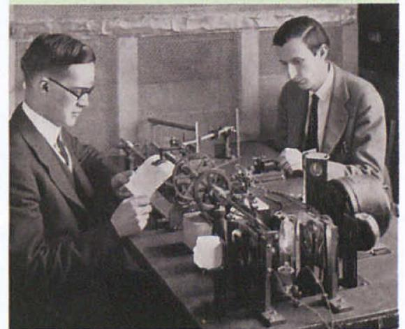
**Apfeltest:** A.C. Hardy (links) betrachtet einen soeben produzierten Spektrenausdruck. In der Mitte steht ein Prototyp des Hardy-Spektrofotometers, am Bildrand rechts befindet sich der untersuchte Apfel. (Die Person rechts ist unbekannt.)
