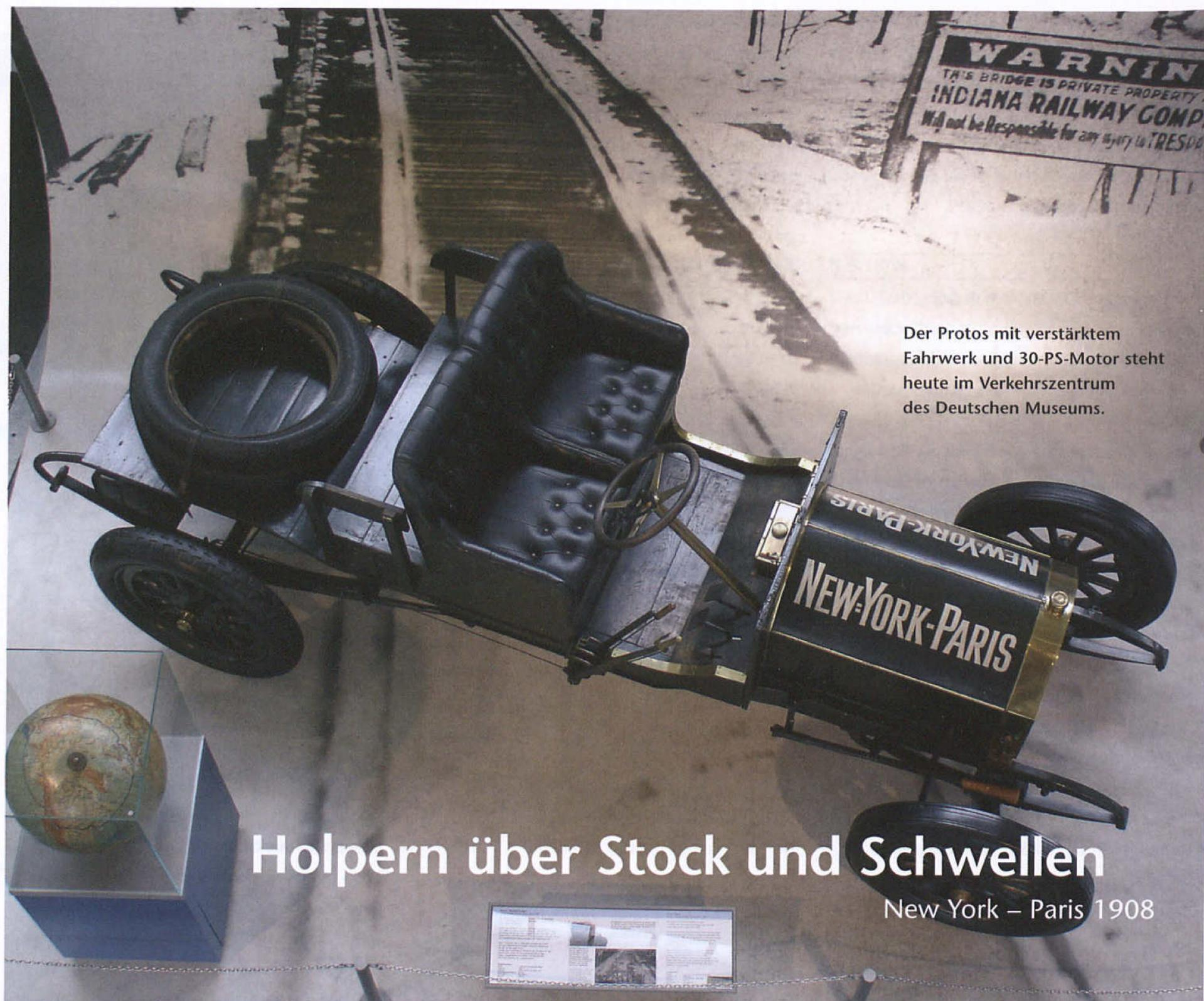
Der Protos mit verstärktem Fahrwerk und 30-PS-Motor steht heute im Verkehrszentrum des Deutschen Museums.
