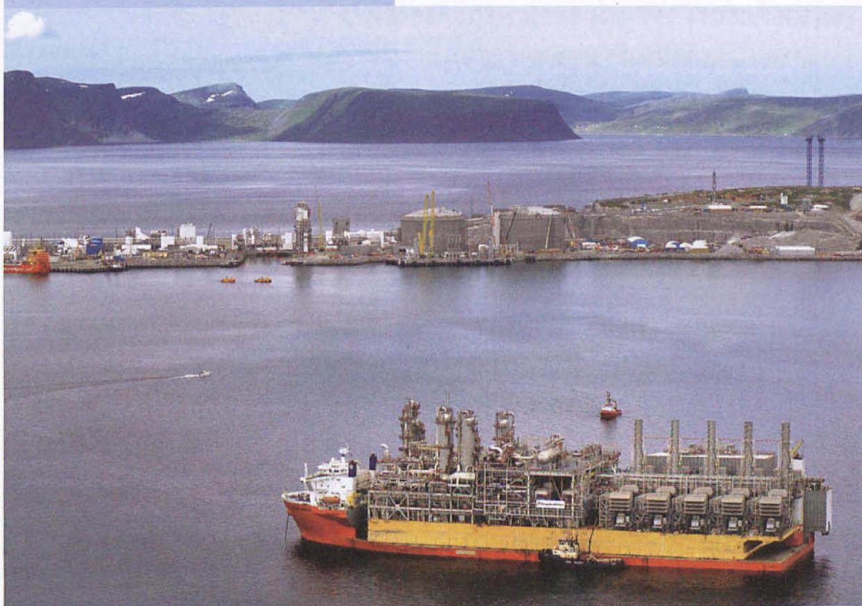
Die Aufnahme zeigt den Seetransport des Kernstückes des Anlagenkomplexes einer Erdgasverflüssigungsanlage auf der Insel Melköya, nahe Hammerfest, knapp 600 km nördlich des Polarkreises. Sieben Milliarden Euro werden in diese Erdgasversorgungsanlage investiert.
