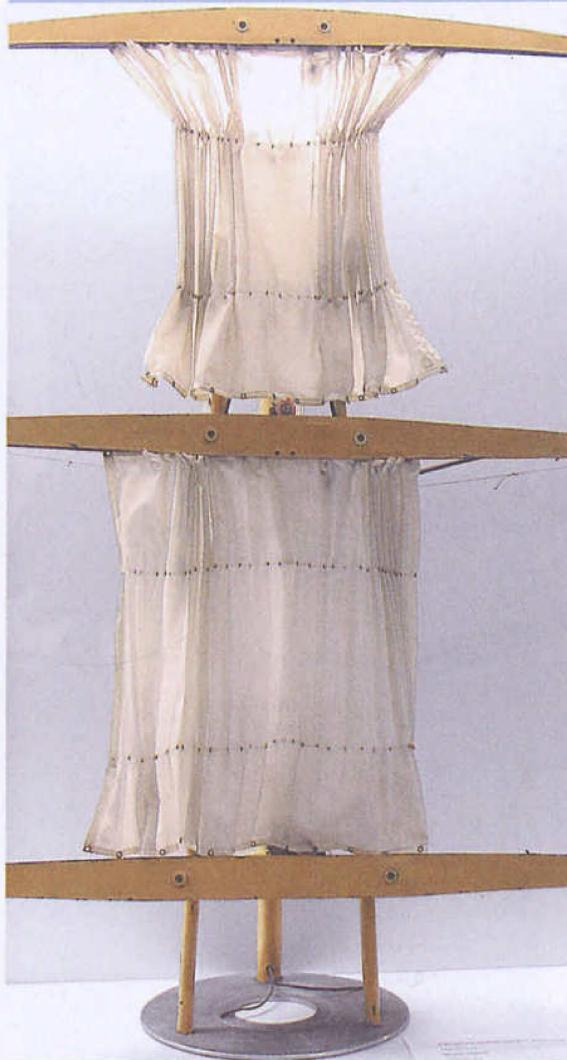
Das Dyna-Rigg bestand aus drehbaren Stahlmasten mit davor gesetzten Rahen, auf denen die Segel zum Setzen wie eine Gardine aufgezo-gen werden sollten. (Funktionsmodell in der Sammlung des Deutschen Museums.)
