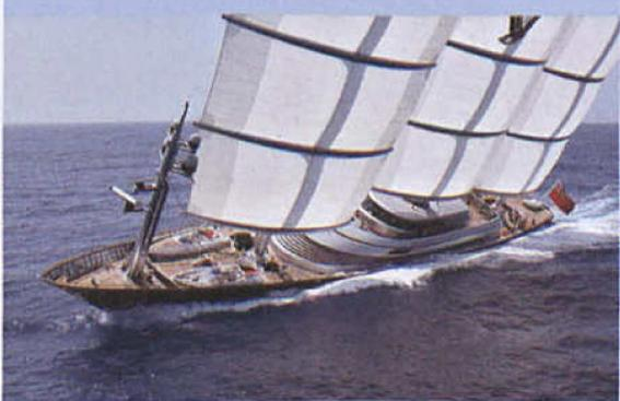
Das Dyna-Rigg auf der Yacht *Maltese Falcon*, 2006. Jeder der 58 Meter hohen Masten aus Kohlefasern wird mit den Segeln gedreht. Wirksamere Segel erzeugen hier aber auch einen größeren Neigungswinkel der Yacht.
