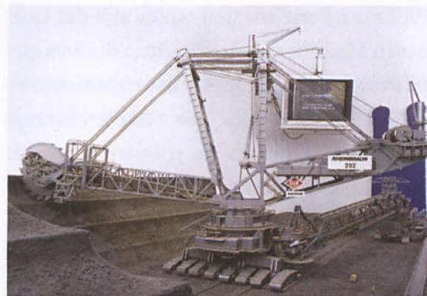
Seit den 1950er Jahren wird Braunkohle im Tagebau mit Hilfe von Schaufelradbaggern mit Raupenfahrwerk und schwenkbarem Oberbau gefördert. Die durch ein Schaufelrad von rund 22 m Durchmesser gewonnene Braunkohle wird über Transportbänder zu einem nahe gelegenen Kraftwerk transportiert. Der Schaufelradbagger mit einer Gesamtlänge von rund 220 m und einer maximalen Höhe von 91 m besitzt eine Dauerleistung von 140.000 m<sup>3</sup> pro Tag und eine Antriebsleistung von 17.600 kW.
