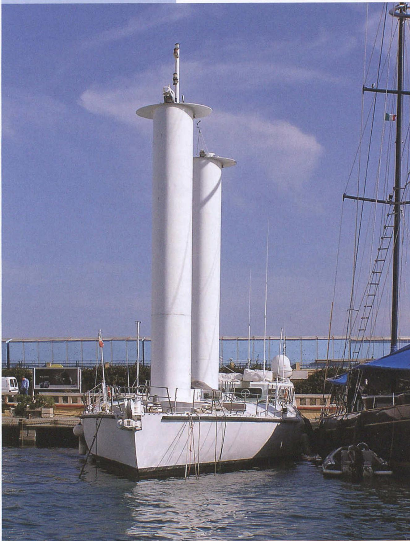
Das Forschungsschiff der Cousteau-Stiftung – *Alcyon* – von 1986, besitzt als Segel zwei starre, dicke Profile mit einer Grenzschichtabsaugung, wie sie bereits in den 1920er Jahren von den Strömungsforschern vorgeschlagen worden war.
