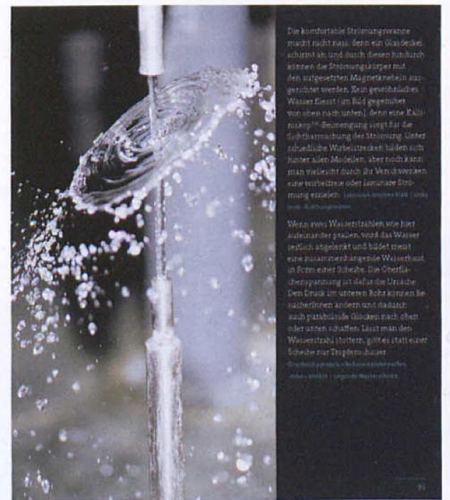
**Das Experiment der liegenden Wasserscheibe: Zwei aufeinanderprallende Wasserstrahlen bilden eine scheibenförmige Wasserhaut.**
