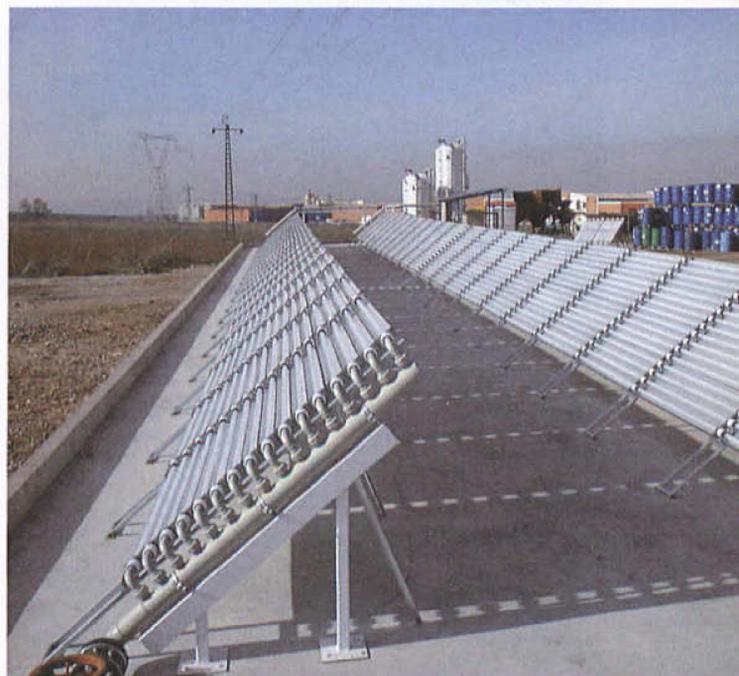
Sonnenlicht und Fotokatalysatoren reichen aus, um verschmutztes Wasser zu säubern. Diese Pilotanlage in Madrid hat sich bereits bestens bewährt. Weitere Anlagen im In- und Ausland sind geplant.
