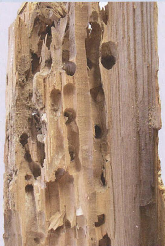
Querschnitt durch eine von der Schiffsbohrmuschel angegriffene Holzplanke. Bemerkenswert ist der scheinbar intakte Bereich direkt unter der Außenhaut. (im Bild auf der rechten Seite)
