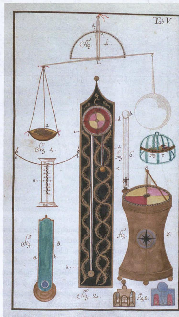
Diese aquarellierte Handzeichnung (um 1773) zeigt verschiedene nautische Messgeräte: Fig. 1: Torricellianisches leuchtendes Wetterglas; Fig. 2: Amontons kleines See-Barometer mit einer gebogenen Röhre; Fig. 3: Amontons großes See-Barometer; Fig. 4: Huygensches Wetterglas; Fig. 5: Reise-Thermometer
