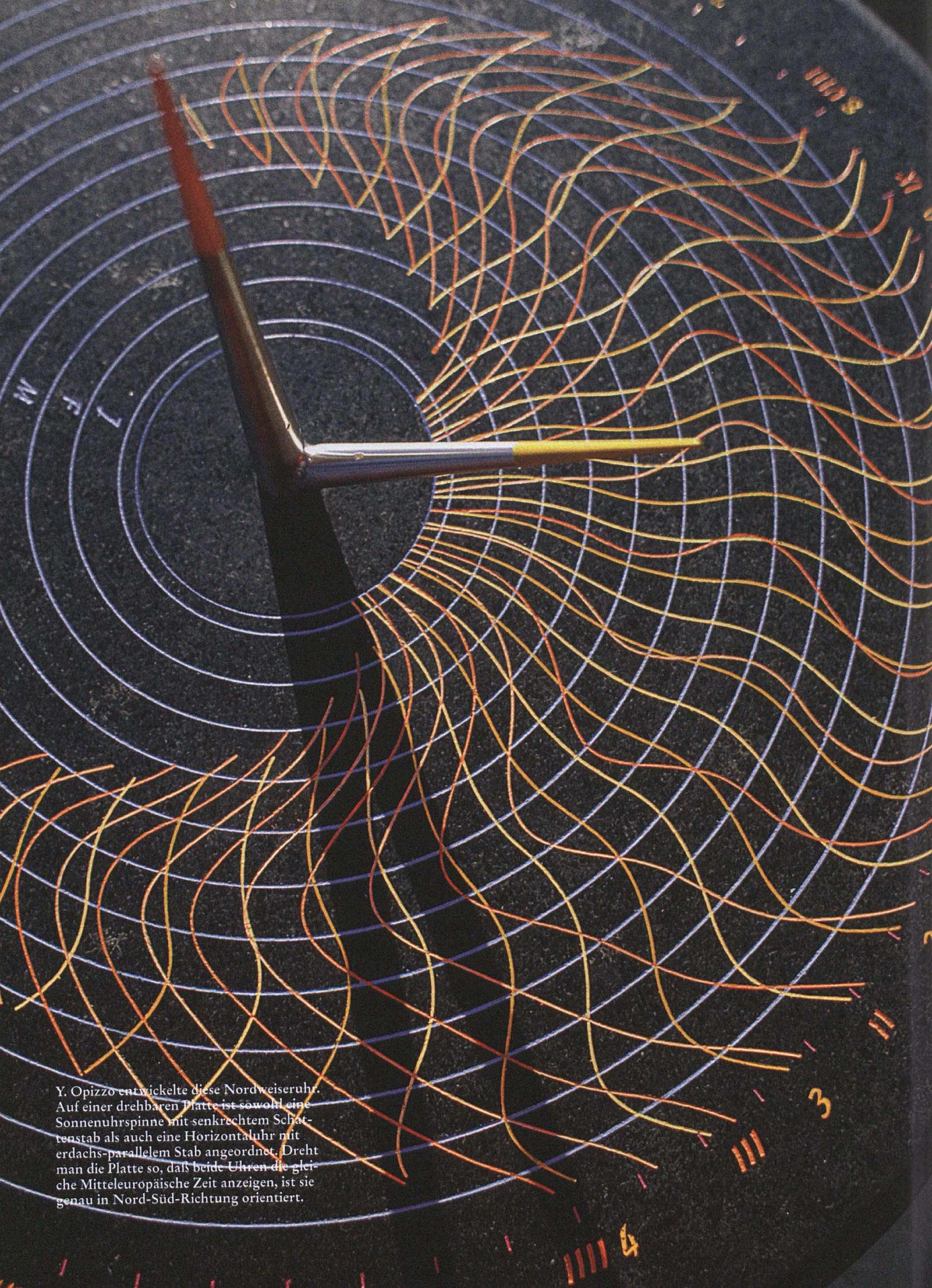
Y. Opizzo entwickelte diese Nordweiseruhr. Auf einer drehbaren Platte ist sowohl eine Sonnenuhrspinne mit senkrechtem Schattenstab als auch eine Horizontaluhr mit erdachs-parallelem Stab angeordnet. Dreht man die Platte so, daß beide Uhren die gleiche Mitteleuropäische Zeit anzeigen, ist sie genau in Nord-Süd-Richtung orientiert.
