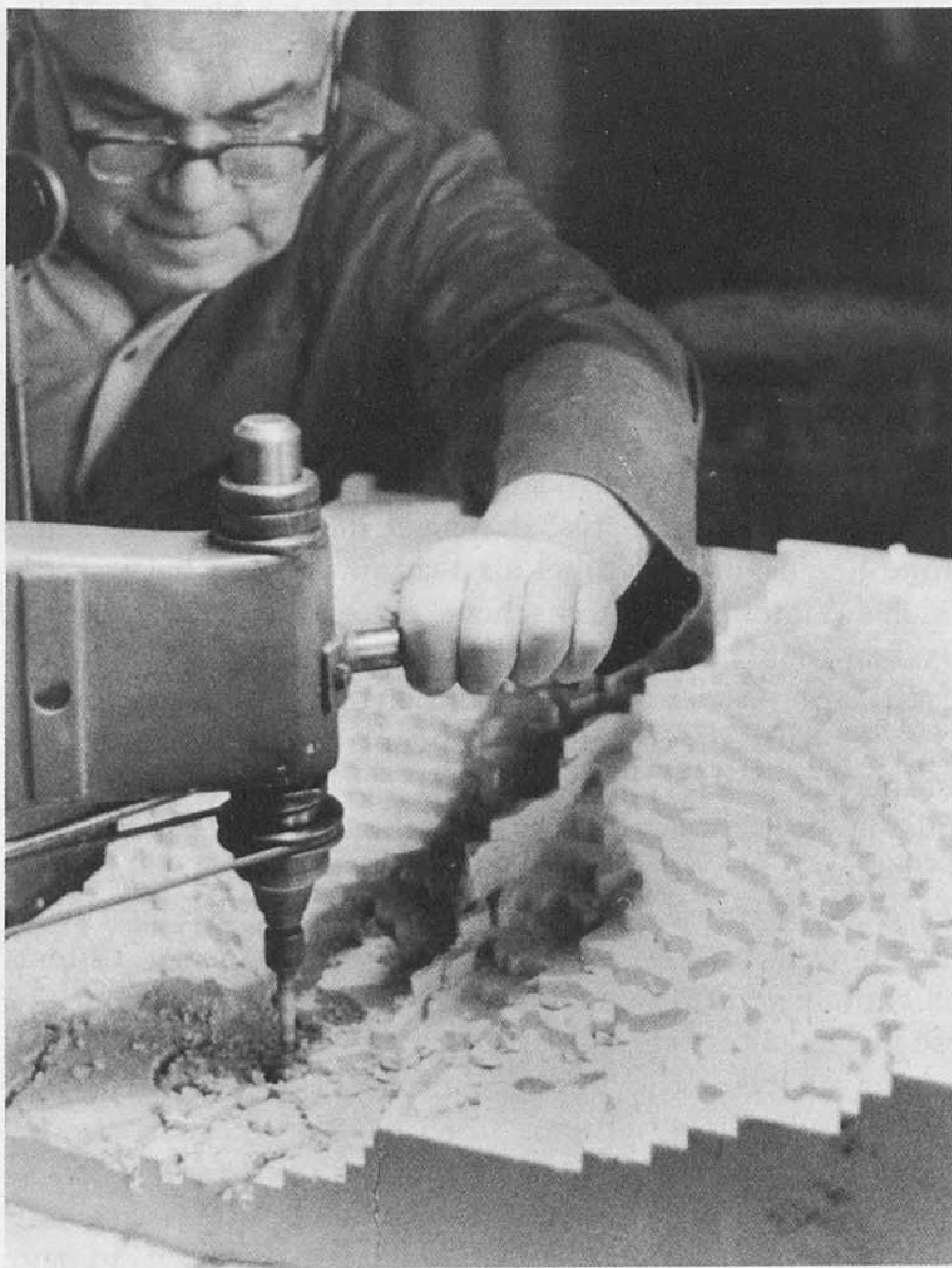
Herstellung eines Rohrelief-Blocks der Deckenform von Altamira mit Hilfe einer Präzisions-Graviermaschine, die die Schichtlinien in den Block einfräst.
