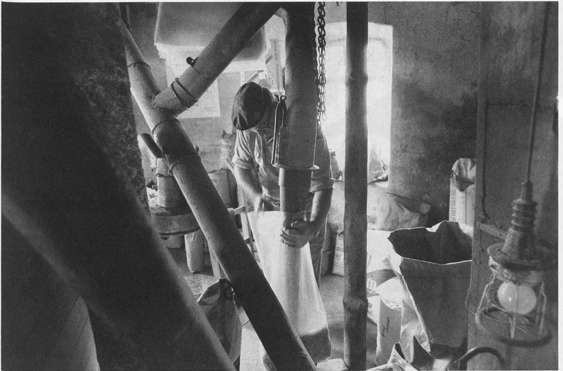
Bei Windstärke fünf schrotet Müller Theodor Steenblock in Spetzerfehn etwa 40 Zentner Getreide pro Stunde.
