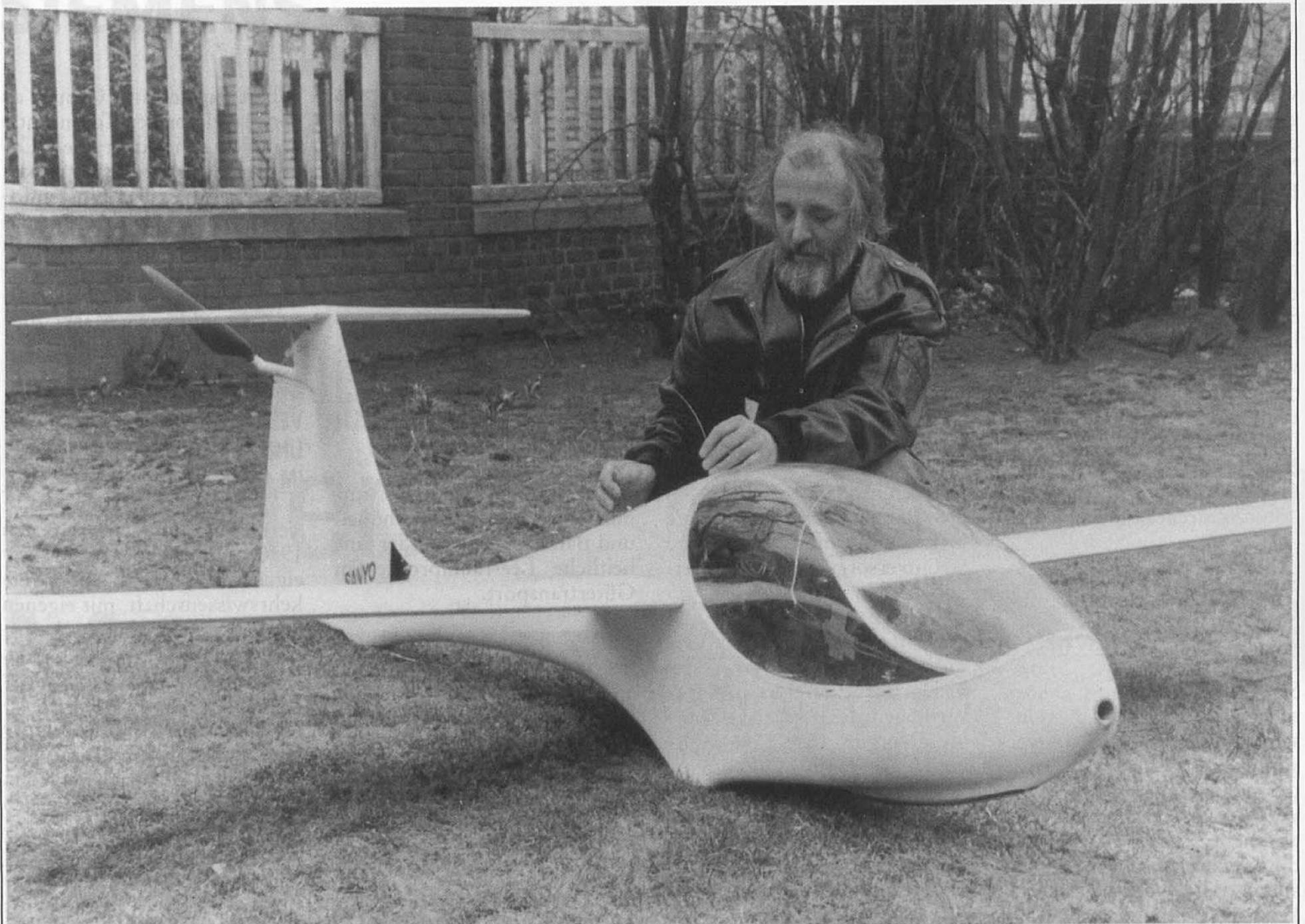
Der Motorsegler „Minair“ von Günter Rochelt ist in extremer Leichtbauweise konstruiert und kann mit einem solargespeisten Elektromotor selbständig starten. Die „Minair“ (im Bild ein Modell 1:2) wiegt nur 90 Kilogramm.
