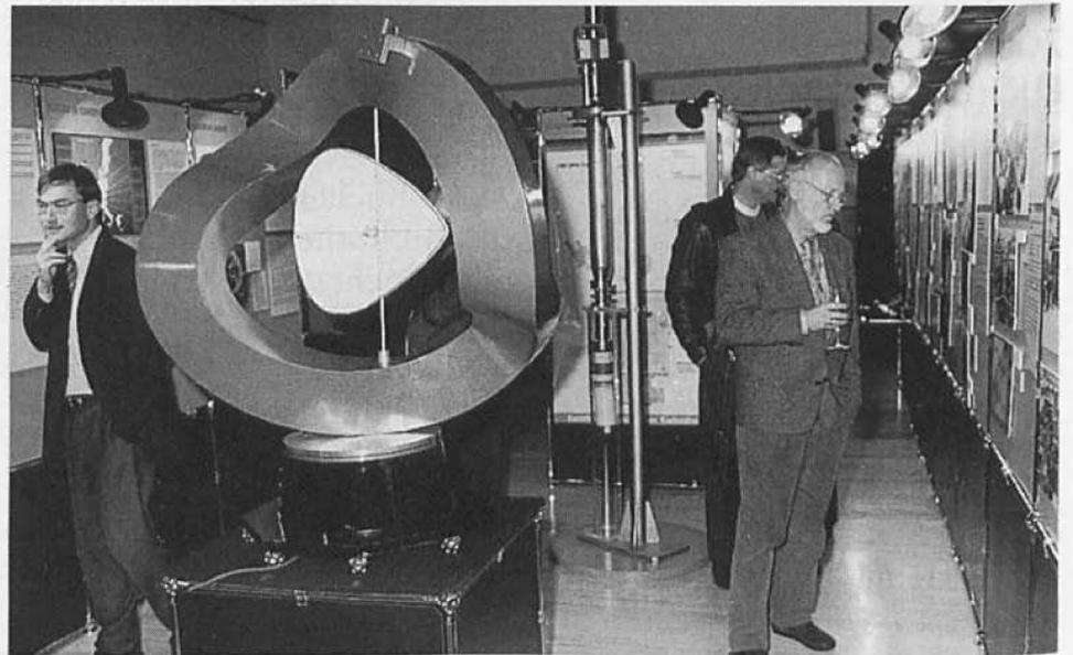
Magnetspule aus einem Stellaratorexperiment.
