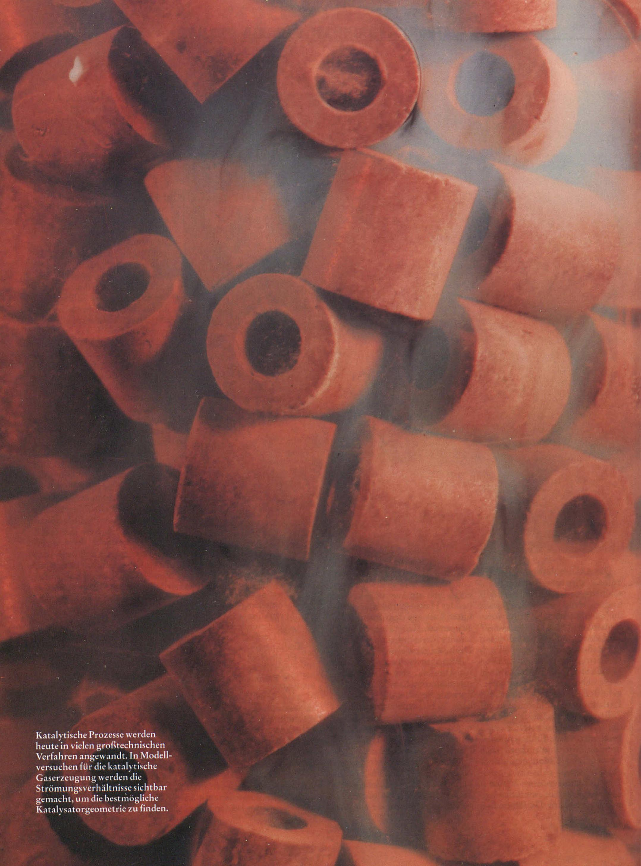
Katalytische Prozesse werden heute in vielen großtechnischen Verfahren angewandt. In Modellversuchen für die katalytische Gaserzeugung werden die Strömungsverhältnisse sichtbar gemacht, um die bestmögliche Katalysatorgeometrie zu finden.
