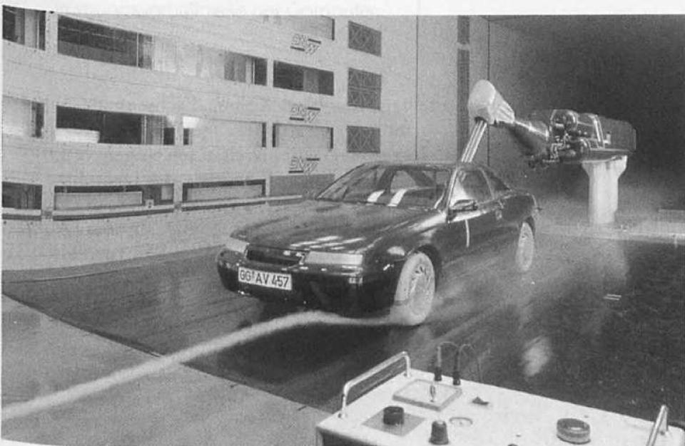
Ein Manko der Windkanaltechnik ist, daß die Relativbewegung zwischen Fahrzeug und Straße nicht simuliert wird. Ein Laufband hilft hier weiter. Der Rauchfaden zeigt die Aufgabenstellung: Das Fahrwerk wird sehr schlecht umströmt; es ist so für die Hälfte des Luftwiderstandes verantwortlich. (Bild: Adam Opel AG, aufgenommen im Deutsch-Niederländischen Windkanal)
