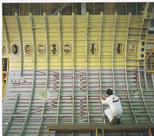
Moderne Aluminium-Anwendung: Airbus-Produktion in Hamburg. (Foto: MBB)
