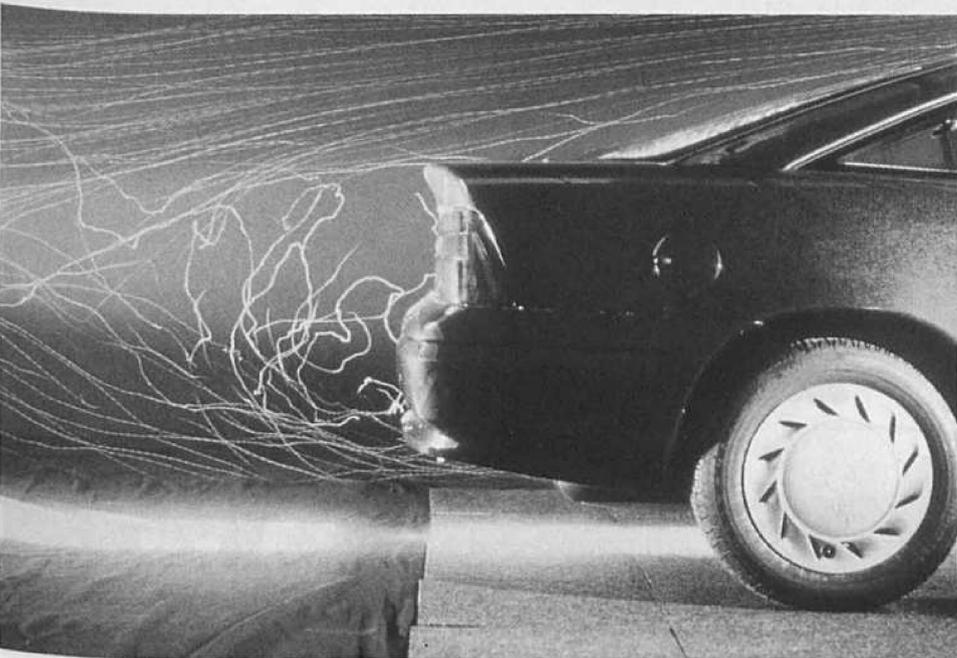
Die mit Helium gefüllten Seifenbläschen lassen erkennen, wie verwickelt die Strömung in Ablösungsgebieten ist. Es wird deshalb wohl noch eine Weile dauern, bis numerische Verfahren dem Fahrzeug-Aerodynamiker brauchbare Resultate liefern. Bis dahin bleibt er auf den Windkanal angewiesen. (Bild: Adam Opel AG, aufgenommen bei Pininfarina, Turin)
