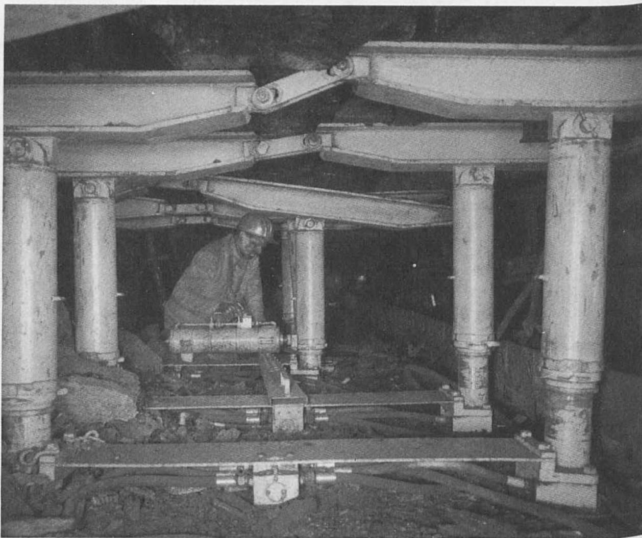
den Gewinnung mit der Schrämmaschine, die gleichermaßen entlang dem Panzerförderer geführt wurde, ganz ähnlich. Ob Kohlenhobel oder Schrämmaschine, das hing im wesentlichen von den Flözverhältnissen ab. Das Problem lag einstweilen in der Nachführung der Maschinen und in der Sicherung des Hangenden durch den Ausbau, und in der Bewältigung dieses Problems lag der zweite bedeutende Fortschritt.
