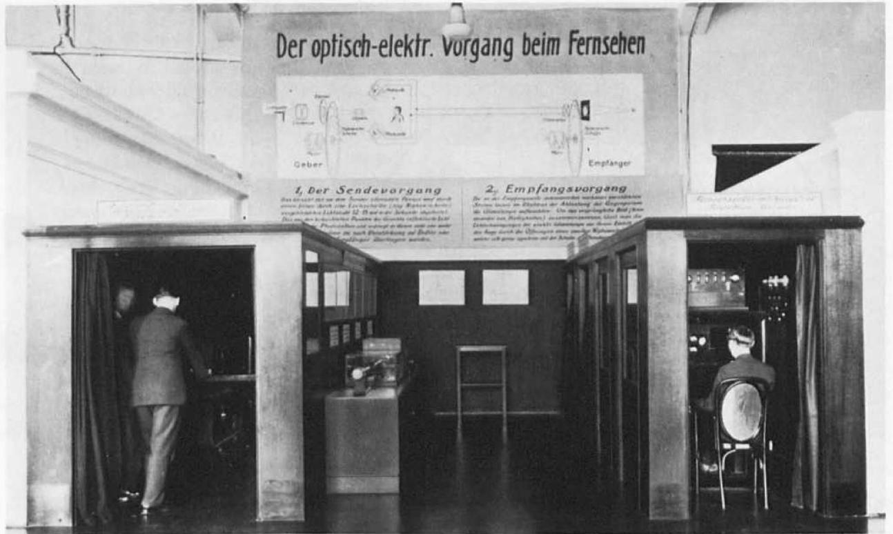
durch Glühlampe Gl und Blende B<sub>2</sub>. Die Glühlampe empfängt die durch Verstärker V verstärkten Signale der Fotozellen Ph der jeweils anderen Zelle, die auf das Licht ansprechen, das der dort Einsitzende reflektiert. Die solchermaßen zustandgekommene Übertragung ging zwar nur über eine Strecke von wenigen Metern, trotzdem – es war die erste deutsche Live-Sendung und die Geburt des öffentlichen Fernsprechens.
